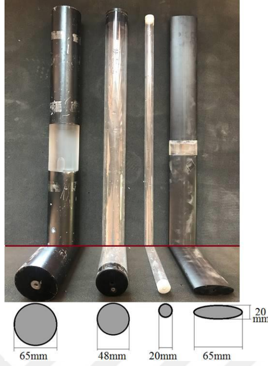
Şekil 3.9. İmal edilen dairesel ve eliptik silindir modelleri
