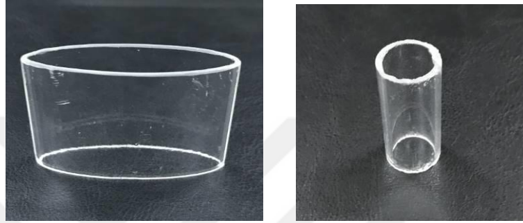
Şekil 3.11. Çoklu dizilim için imal edilen eliptik silindir ve dairesel silindir
