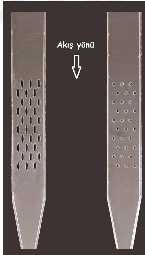
Şekil 3.12. Eliptik ve dairesel silindirlerin çoklu dizilimlerine ait deneysel modeller
