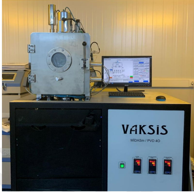
Şekil 3.5. Vaksis Midas/PVD 40 termal buharlaştırma sistemi.
