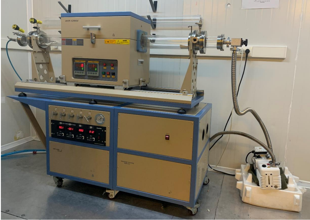
Şekil 3.3. MTI-OTF 1200 düşük basınçlı Kimyasal Buhar Biriktirme (CVD) cihazı.
