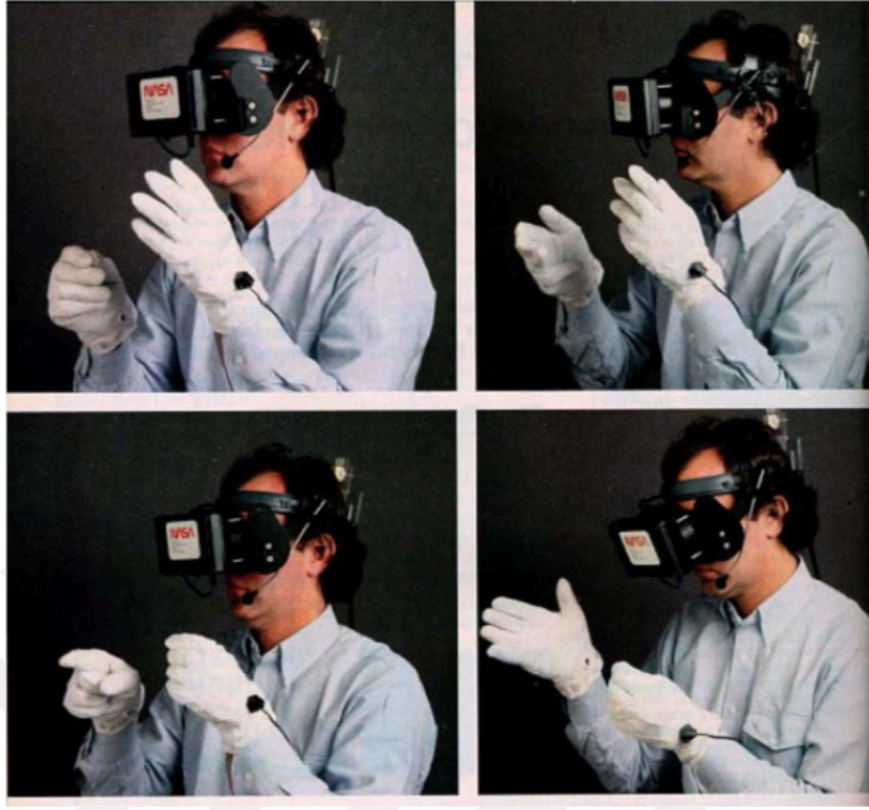
Şekil 4.23 1980’lerde NASA’ da tasarlanan başa takılı sunum aleti (Brown, 2003)
