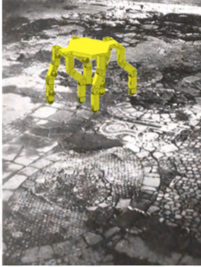
Şekil 5.23 Kaldırım yüzeyindeki bozukluklar ve robotun simülasyonu (Cigola ve Ceccarelli, 2013)
