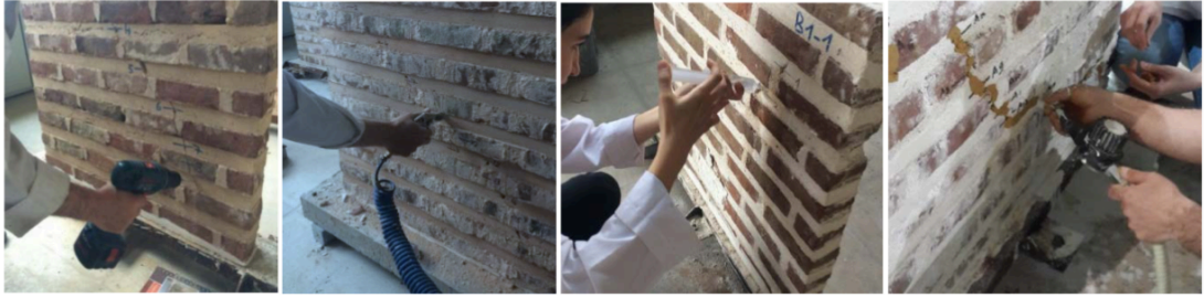
Şekil 6.97 Örnek enjeksiyon uygulaması (Oktay ve Yüzer, 2017)
