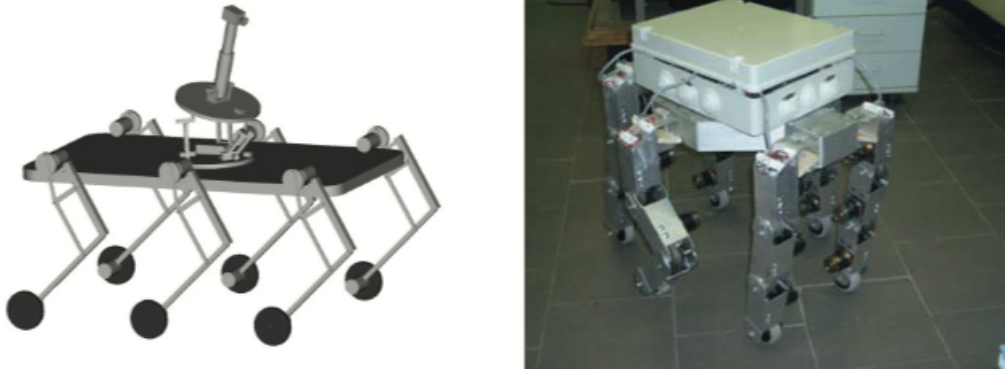
Şekil 4.15 Mimari korumada keşif için kullanılan bir robot (Cigola ve Ceccarelli, 2008)
