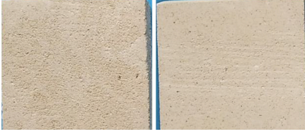
Şekil 6.86 NanoF uygulanmamış (solda) ve uygulanmış (sağda) taş yüzeyi (Masieri, Morelli, Pipoli, 2018)
