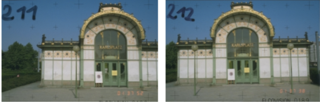
Şekil 4.4 Stereo görüntü yönteminde çekilen sol ve sağ fotoğraflar (Hanke ve Grussenmeyer, 2002)
