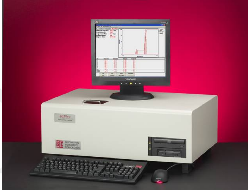
Şekil 3.2 Nano boyutta çalışan zeta analiz cihazı (BOUN, b.t.)
