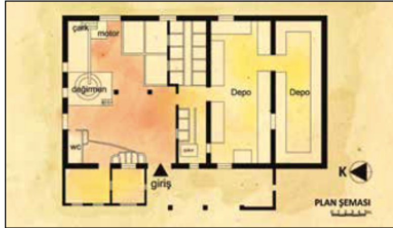
Şekil 6.33 Yeni Şakran'da bulunan zeytinyağı fabrikası yağhane plan şeması (Manisa ve Yerliyurt, 2018)
