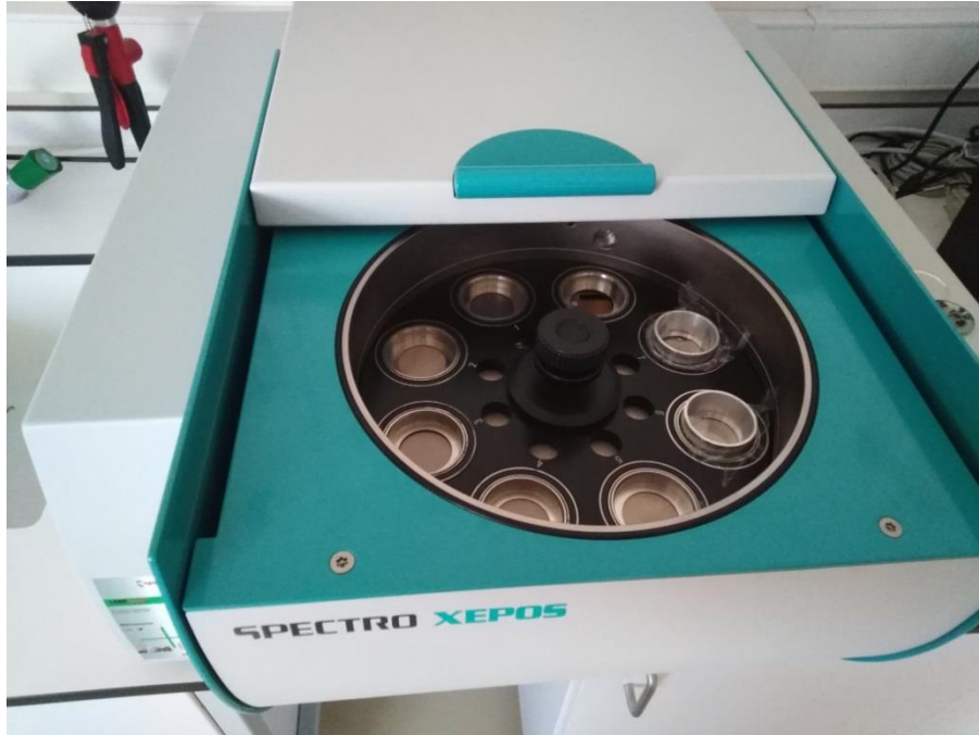
Fotoğraf 3.2 EDXRF spektrometresinin örnek alma cihazı
