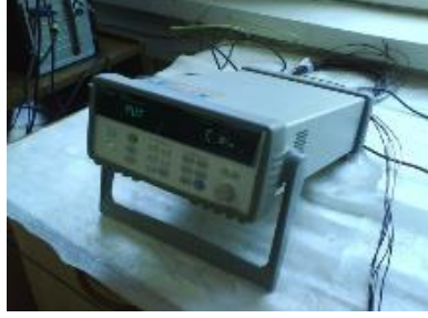
Şekil 3.4. Agilent Model No: 34970A veri kayıt cihazı (Data-Logger)
