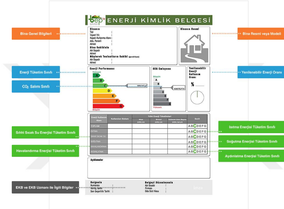
Şekil 0.2. Enerji kimlik belgesi (Binalarda Enerji Performans Yönetmeliği, T.C. Resmi Gazete, 5.12.2008 Tarih ve 27075 Sayı)
