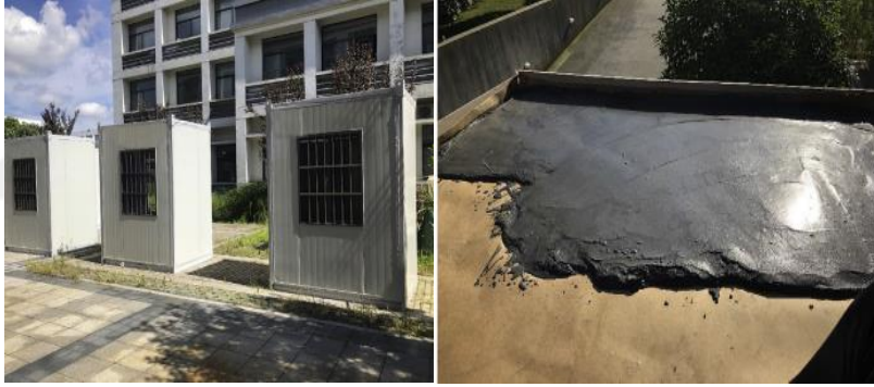
Şekil 0.3. Proje de kullanılan 3 test binası ve FDM beton çatı (Meng ve ark.,2019)
