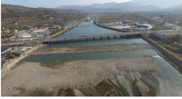
a) Köprü mansap yönünde yatak tanzimi ve bit yapısına ait drone görüntüsü.
