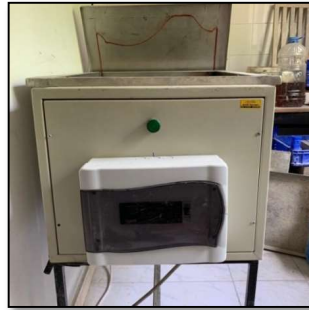
Şekil 3.13 Sıcak su ve buhar kürleme tankı
