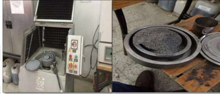
Şekil 3.3 PK taşlama için kullanılan Halkalı değirmen öğütücü
