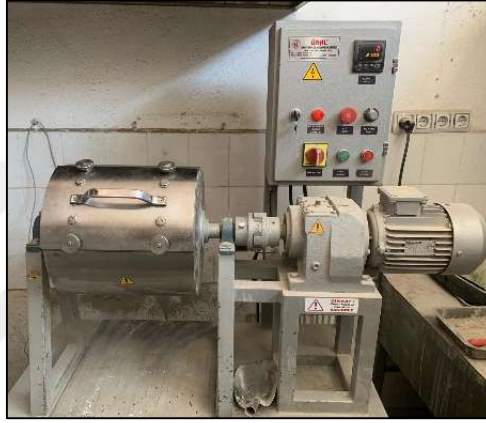
Şekil 3.7 YFC öğütülmesinde kullanılan bilyalı değirmen
