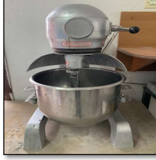
Şekil 3.10 Harçların karıştırılmasında kullanılan karıştırıcı
