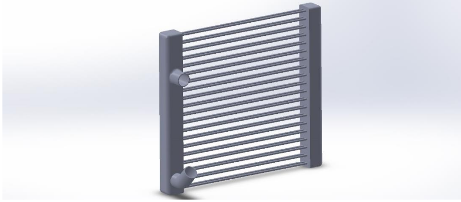
Şekil 3.5. Bu çalışmada incelenen otomobil radyatörünün 3 boyutlu katı model görünüşü
