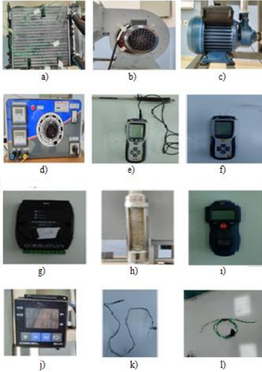
Şekil 3.4. Deney düzeneğinde kullanılan temel ekipmanlar ve ölçüm cihazları a)Radyatör, b)Santrifuj Fan, c)Santrifuj Pompa, d)Varyak, e)Hotwire Anemometre, f)Pitot tüpü, g)Datalogger, h)Debimetre, ı)Takometre, j)Termostat, k)K Tipi Termokopul prob l) K Tipi Termokopul Kablo
