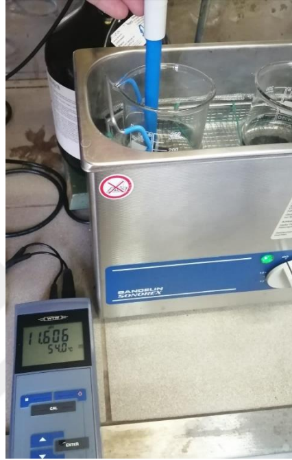
Şekil 3.5. CoFe 2 O 4 karışımının pH 11'e ayarlanması.
