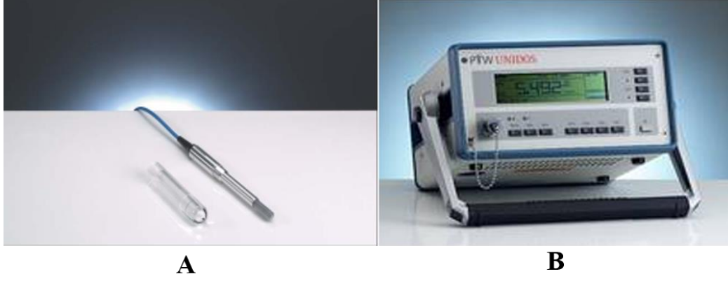
Şekil 3.7. (A) PTW Farmer tipi iyon odası (b) PTW Wepline Elektrometre (Akdeniz Üniversitesi Radyasyon Onkolojisi Anabilim Dalı).
