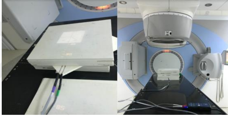
Şekil 3.31. Yaniletken MOSFET Dozimetrelerin Kalibrasyon Düzeneği.
