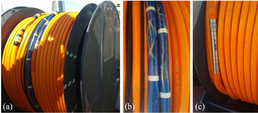
Şekil 3.4 : Deniz yansıma sismiği çalışmalarında kullanılan alıcıların genel yapısı. (a) Makara üzerinde sarılı streamer (alıcı kablosu), (b) streamer üzerindeki hidrofonlar ve (c) sayısallaştırıcılar.
