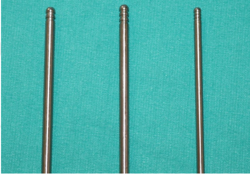
Şekil 10: Ultrasonik enerji aktarımında kullanılan probalar. Çalışmamızda kullanılan 3,7 mm çaplı üç oluklu prob (ortada)
