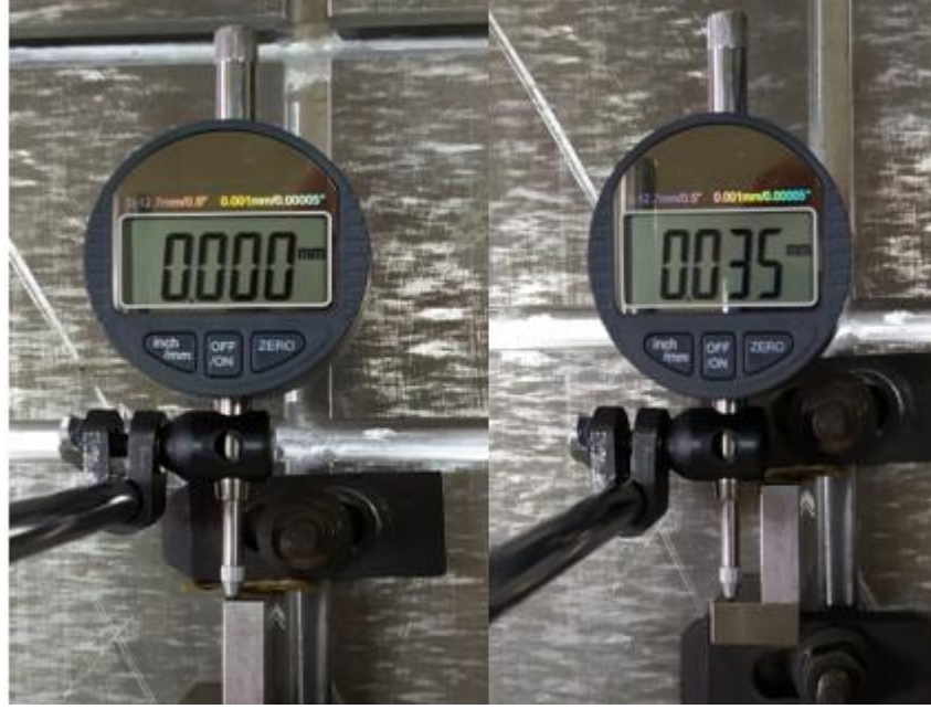
Şekil 5.3. Komparatörün Y eksenindeki hassasiyet ölçümü.
