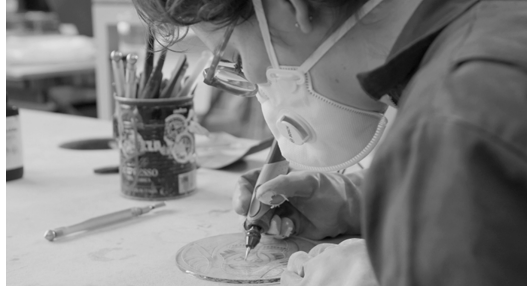
Görsel 3.6. Motorlu el aleti ile kazıma
