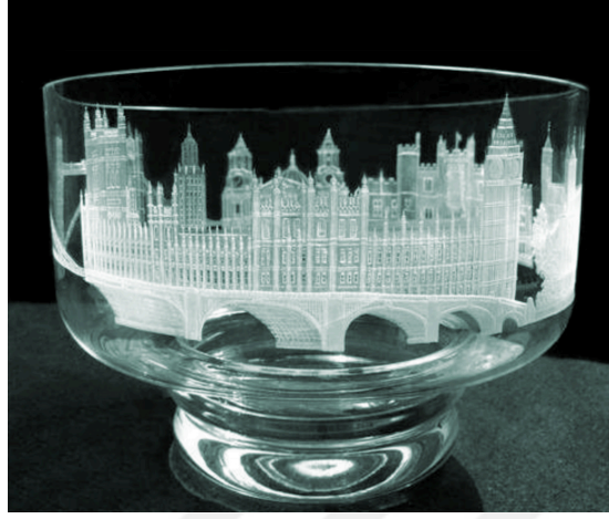
Görsel 1.34. Lazer ile yüzeysel cam kazıma
