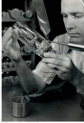
Görsel 3.1. Bakır disk ile kazıma
