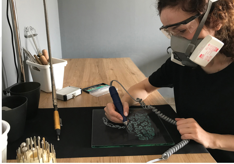
Görsel 4.5. Esnek şaftlı motor ve Mikromotor ile kazıma
