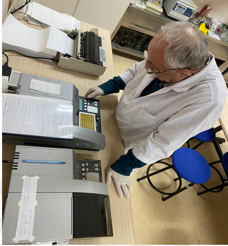
Şekil 5: Mikroplate Okuyucuda Optik Yoğunlukların Saptanması
