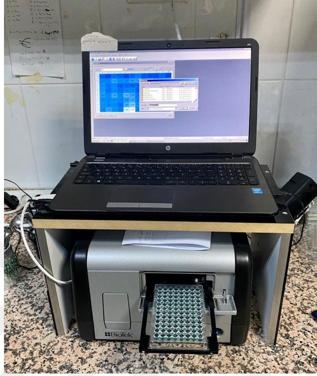
Şekil 6: TAS ve TOS Sonuçlarının Mikroplate Okuyucuda Belirlenmesi
