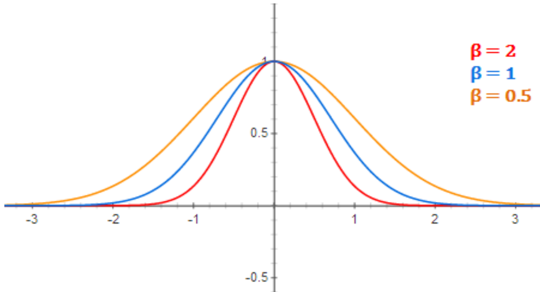
Şekil 2.12 : RBF nöron aktivasyonu (Gauss Dağılımı).
