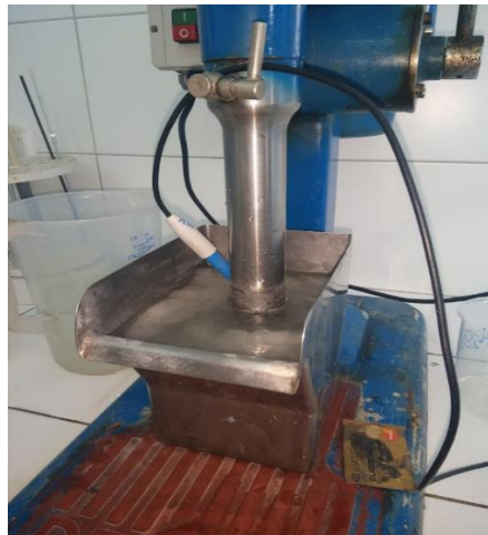
Şekil 3.5: Deneysel çalışmaların yapıldığı Denver tipi flotasyon makinası.
