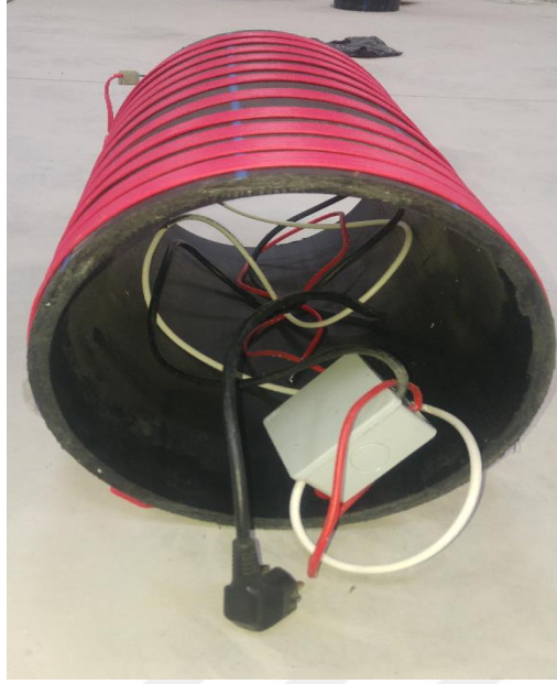
Şekil 3.5. Isıtma sistemi ve kontrol paneli.
