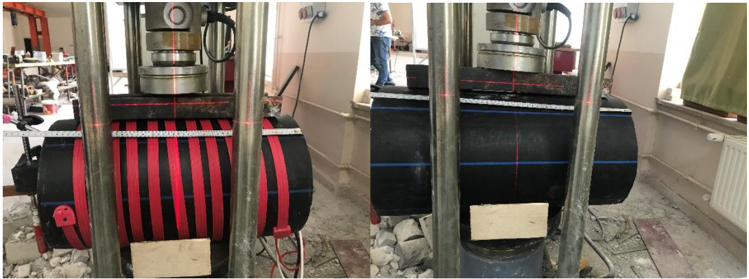
Şekil 4.1. Isıtıcı bandın sarmal etki deney düzeneği.
