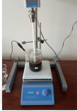
Şekil 3.16 Tüm karışımların 70°C’de 1 veya 2 saat karıştırılması
