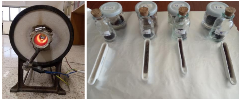
Şekil 4.7 500°C, 700°C ve 900°C de 1 saat kalsine etme
