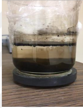
Şekil 3.4 Mıknatıs yardımıyla partiküllerin çökmesi
