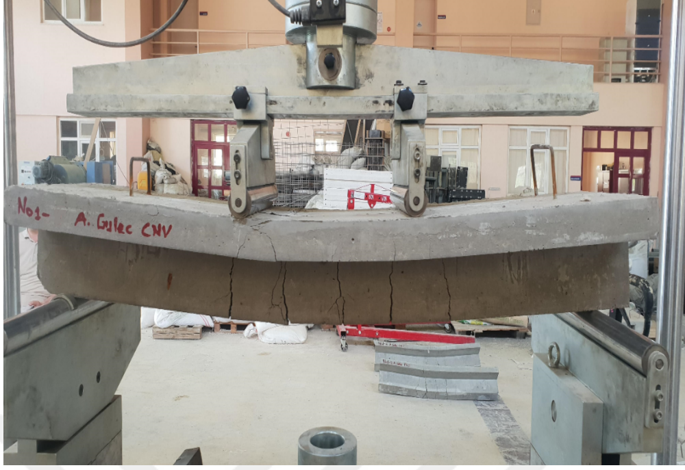
Şekil 4.16 Nihai kapasitesine ulaşmış T kesitli geleneksel donatılı kiriş
