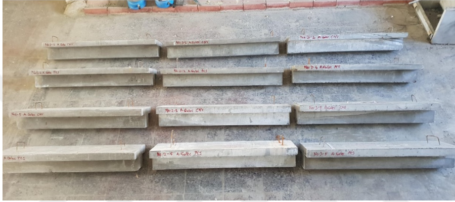
Şekil 3.19 Kalıptan çıkarılmış T kesitli numuneler
