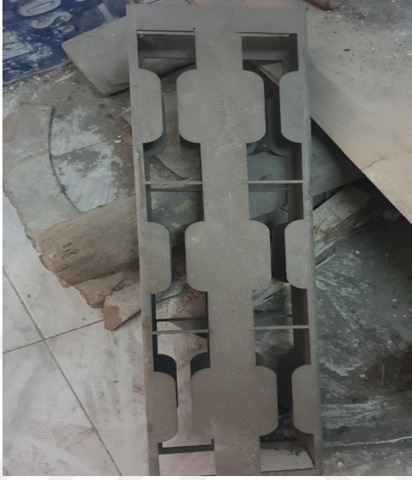
Şekil 3.6 Lazer kesim metodu ile kupon numune alınan kutu profil
