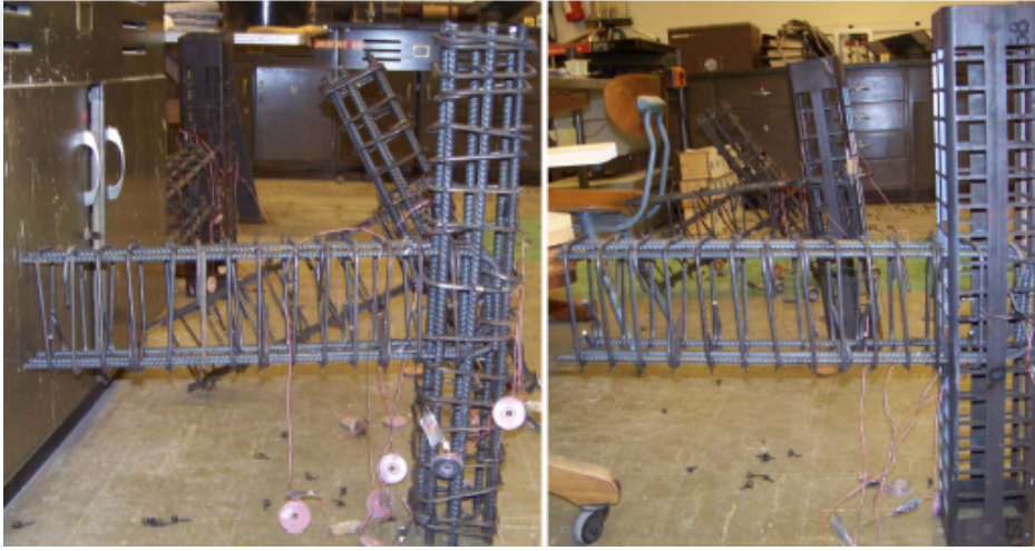
Şekil 2.13 Geleneksel donatılı ve PCS donatılı kolon-kiriş birleşim örnekleri (Fisher ve Sezen, 2011)
