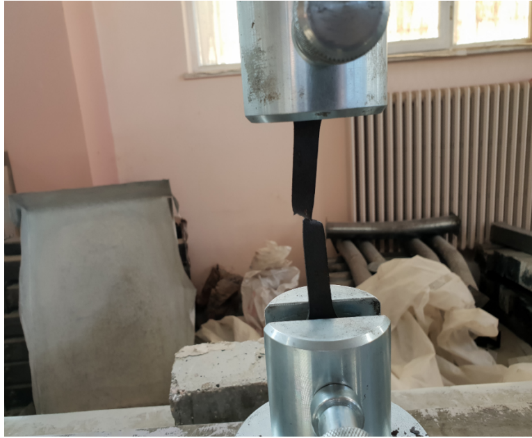
Şekil 3.7 Kupon numunelere uygulanan çekme deneyi
