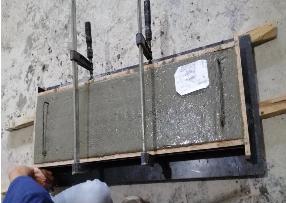
Şekil 3.18 Kalıptaki taze dökülmüş beton
