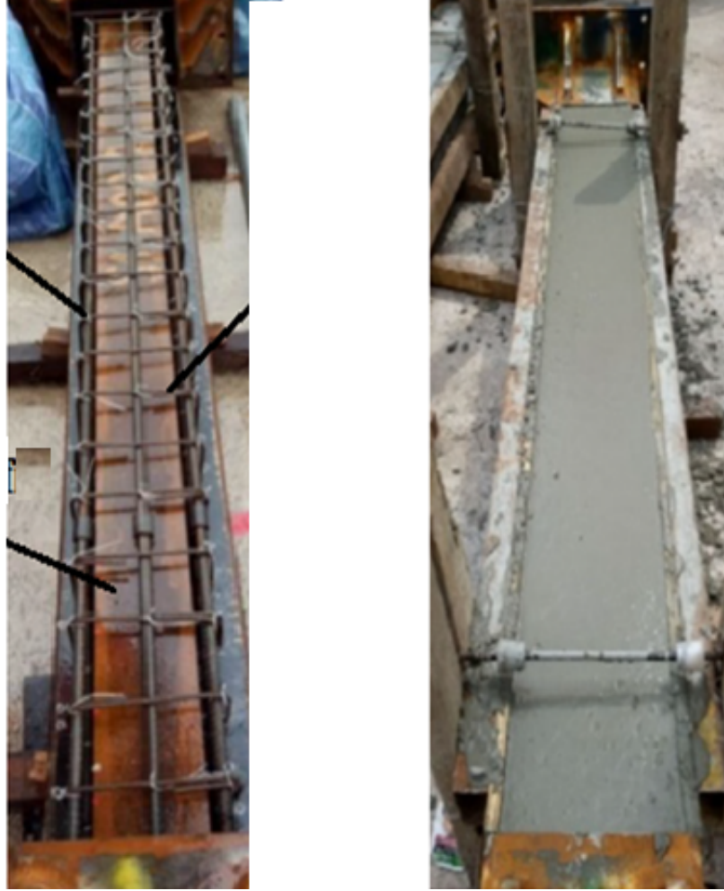
Şekil 2.10 Çelik kompozit kolonun hazırlanışı (Lai ve ark., 2019)
