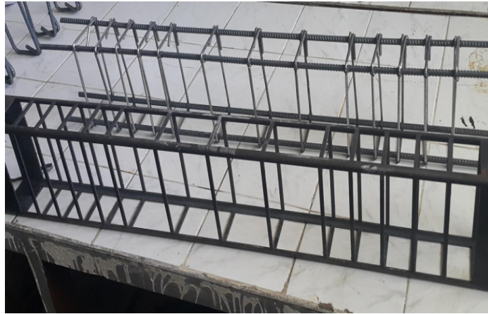
Şekil 3.14 Eşdeğer donatı alanına sahip geleneksel ve PCS donatı sistemleri
