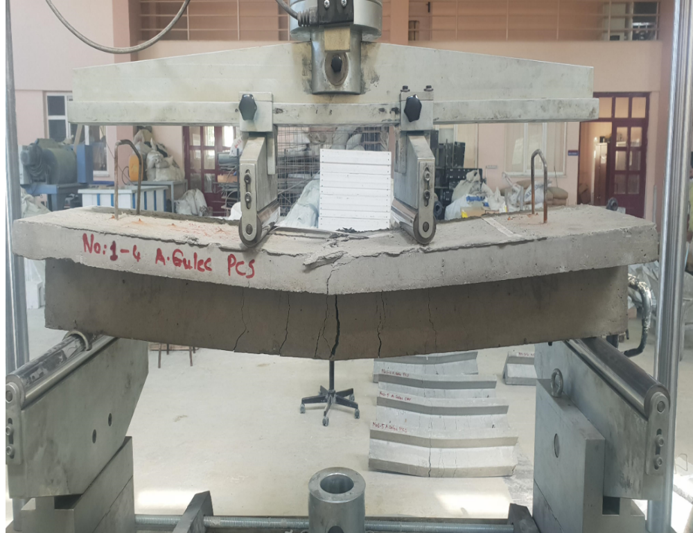
Şekil 4.17 Nihai kapasitesine ulaşmış T kesitli PCS donatılı kiriş
