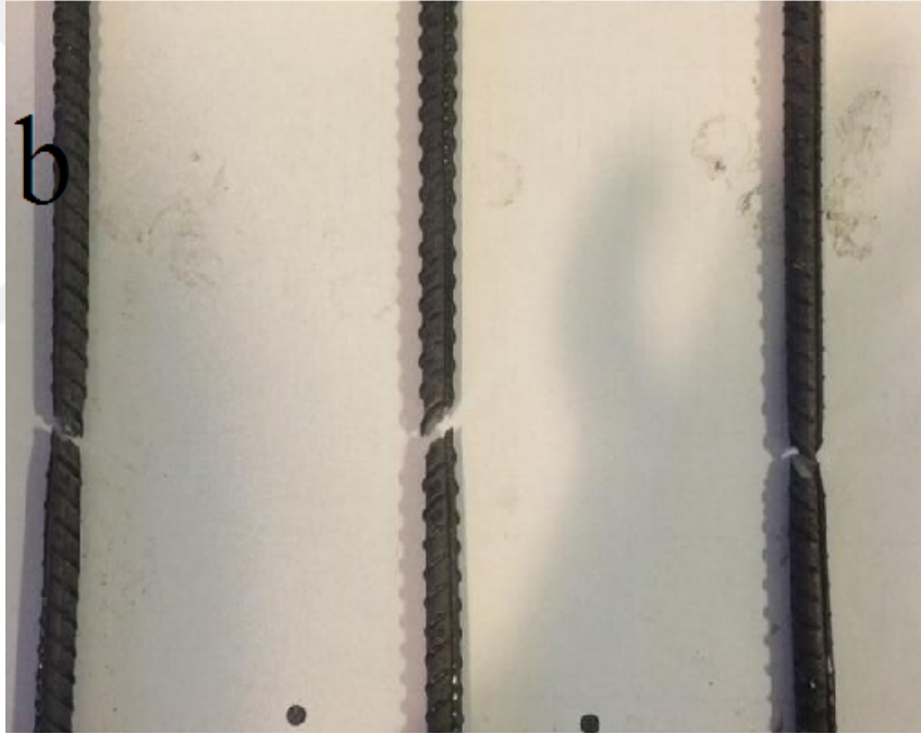
Şekil 3.9 Çekme testinde kullanılan inşaat çelik numuneleri a) Numunelerin çekme testinden önceki durumları b) Numunelerin çekme testinden sonraki durumları
