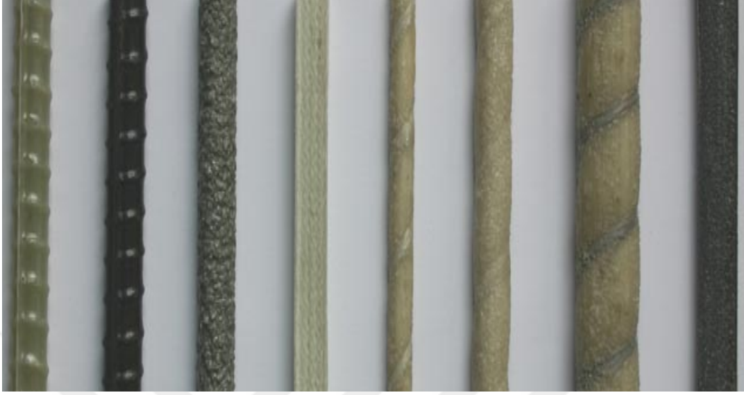
Şekil 2.4 Değişik tiplerde FRP donatı örnekleri
