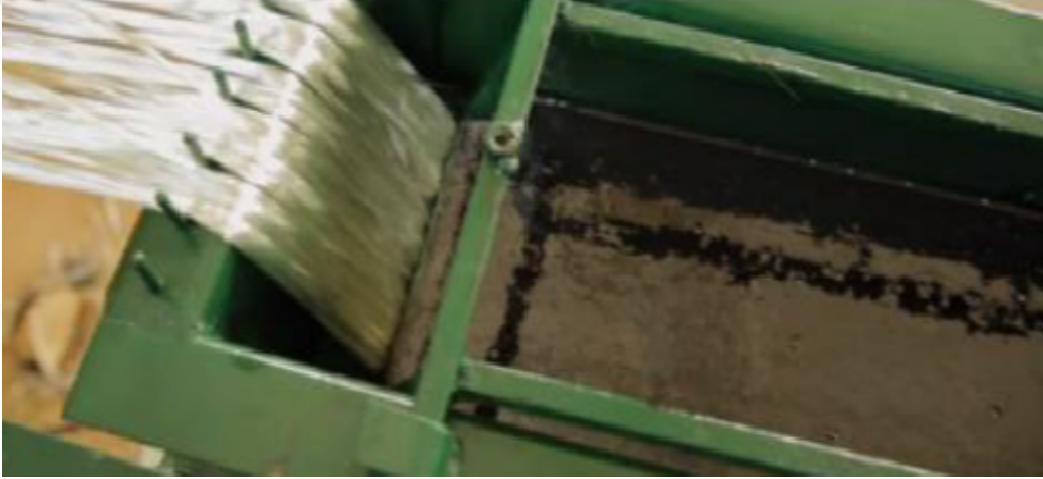
Şekil 2.5 Takviye elemanlarının reçineye daldırılması işlemi (Durmaz,2018)
