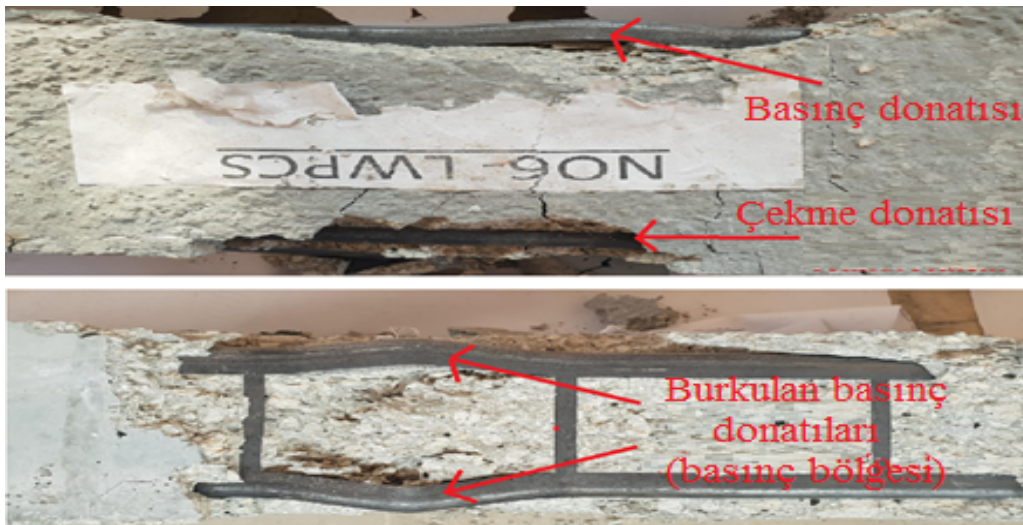
Şekil 4.3 Çekme donatısında akma, basınç donatısında burkulma davranışı
