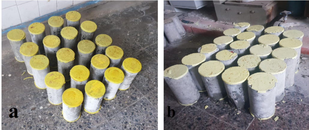
Şekil 3.2 Kükürt başlık yapılmış silindir numuneler a) Test öncesi b) Test sonrası
