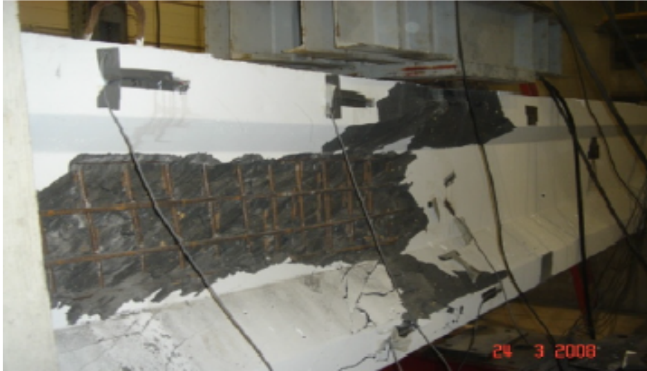
Şekil 2.8 Hasır kaynaklı donatılı I tipi betonarme kirişin test esnasındaki durumu Akhnoukh ve Xie (2010)
