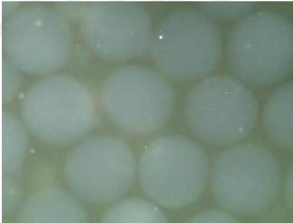
Şekil 2.5. Mikroskop ışığı altında hidrojel adsorbentin görüntüsü
