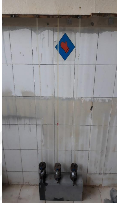
Őekil 19. Düşen seviyeli geçirimlilik deney düzeneđi
