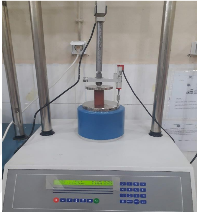
Şekil 17. Serbest basınç deney düzeneği
