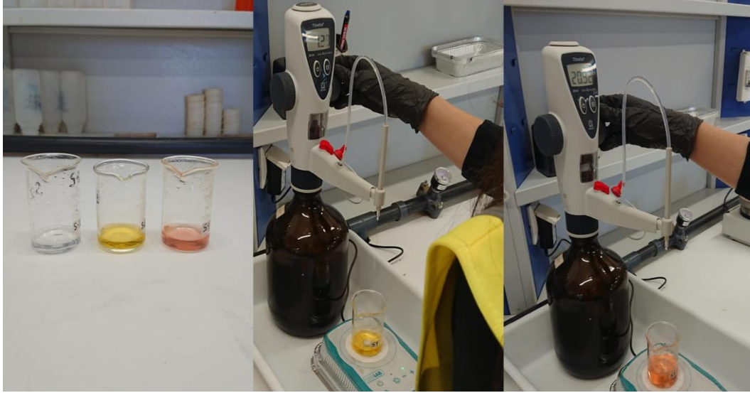
Şekil 5.9 : \text{AgNO}_3 Titrasyonu ile serbest siyanür ölçümü
