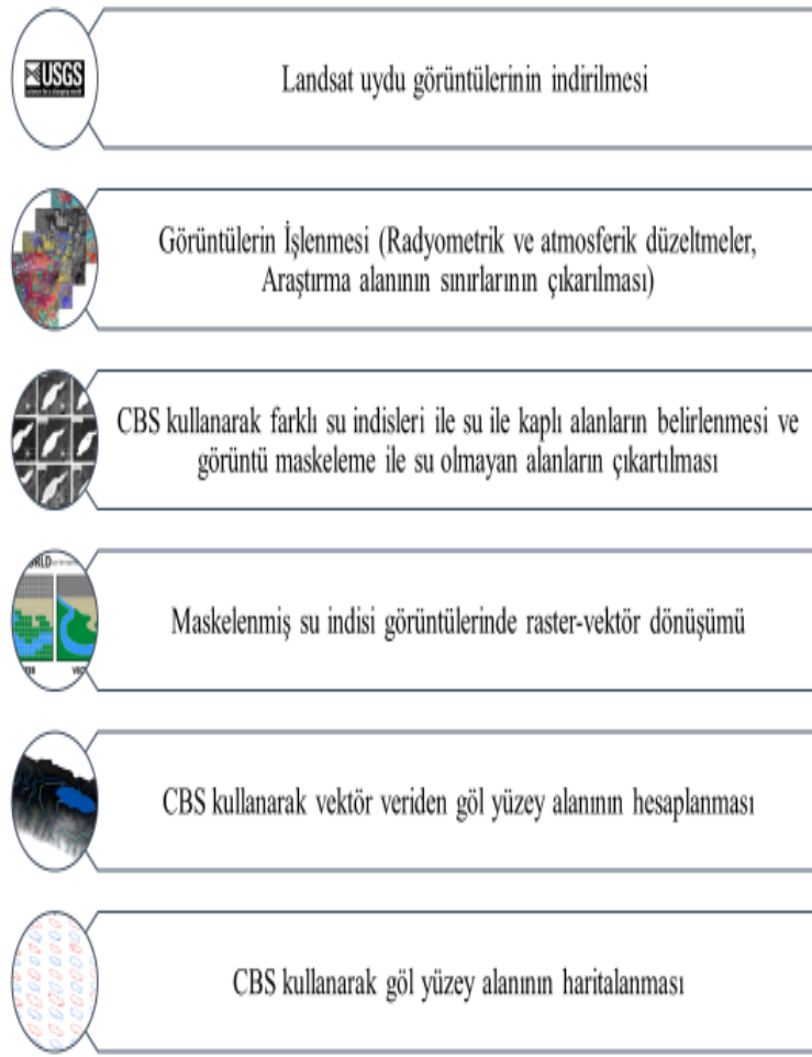
Şekil 3.3: Göl yüzey alanının belirlenerek haritalanması için kullanılan iş akış şeması
