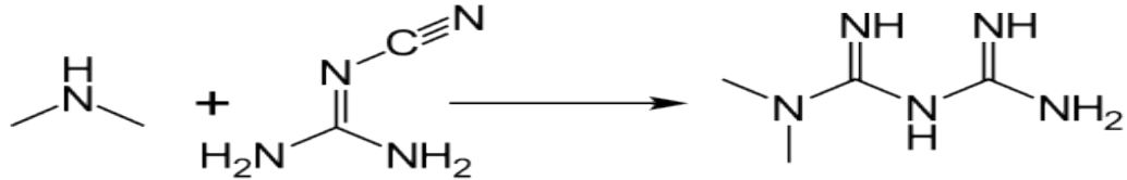
Şekil 3.17 : Metforminin sentez mekanizması [65].
