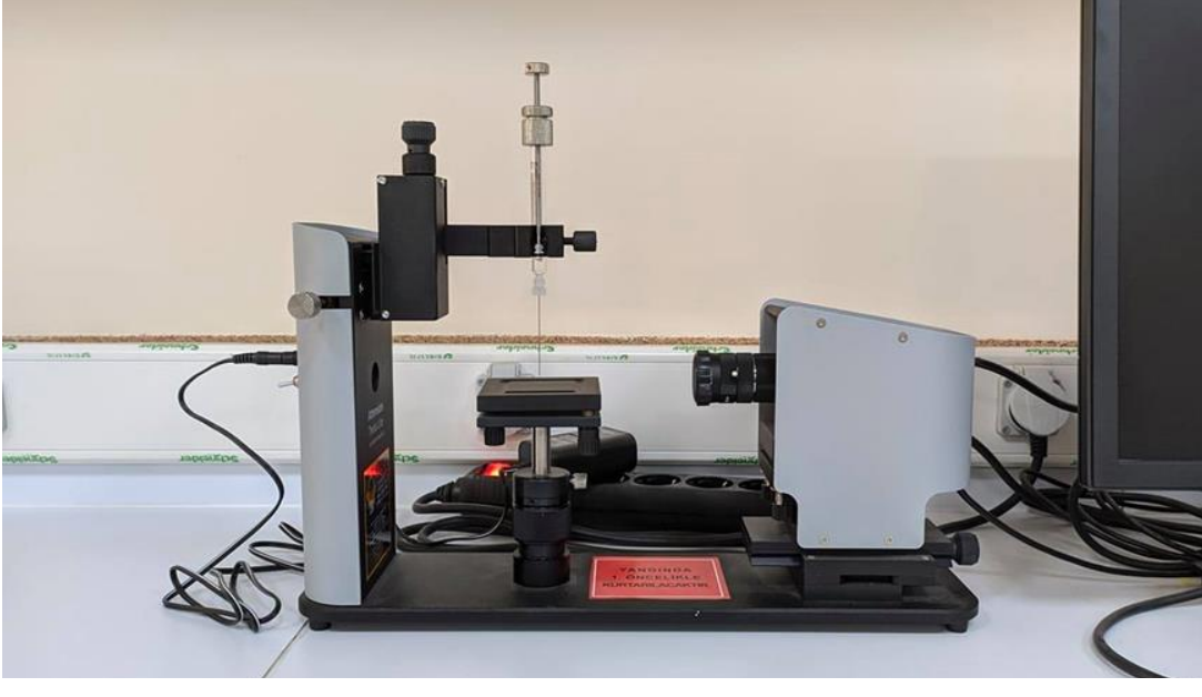
Şekil 3.9 : Biolin scientific theta lite tl 101 marka kontak açı cihazı.
