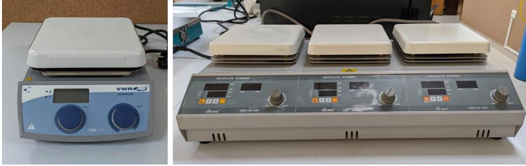
Şekil 3.3 : Vwr-vms-07 ve mtops hsd150-03p ısıtıcılı karıştırıcı.
