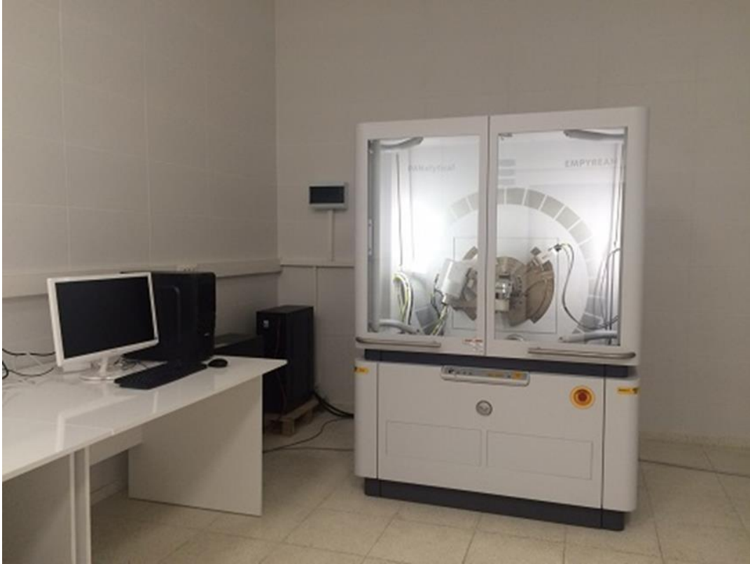
Şekil 3.13 : Panalytical empyrean marka XRD cihazı.
