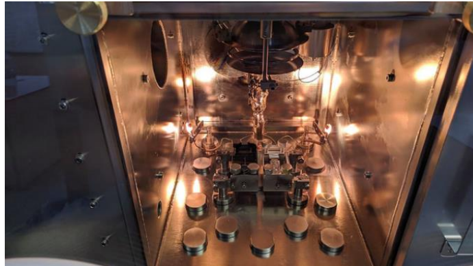
Şekil 3.6 : Fiziksel buhar biriktirme cihazı.
