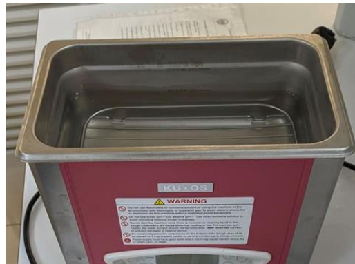
Şekil 3.1 : Kudos-sk2210hp marka ultrasonik su banyosu.
