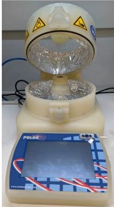
Şekil 3.4 : Polos-spin-150-i marka dönel kaplama cihazı.
