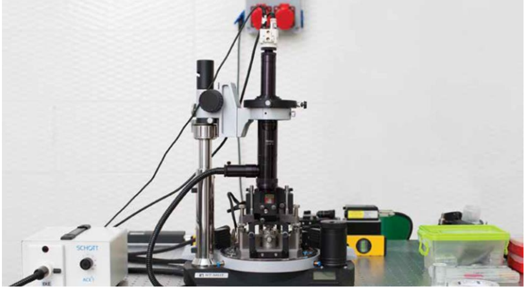
Şekil 3.11 : Nt-mdt ntegra solaris marka atomik kuvvet mikroskobu.
