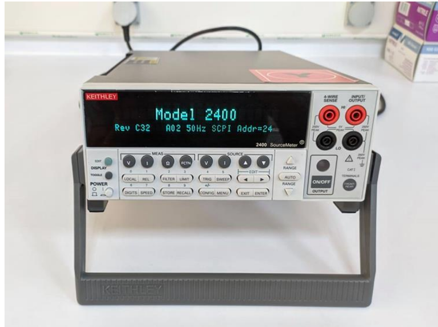
Şekil 3.8 : Keithley 2400 akım gerilim kaynağı.
