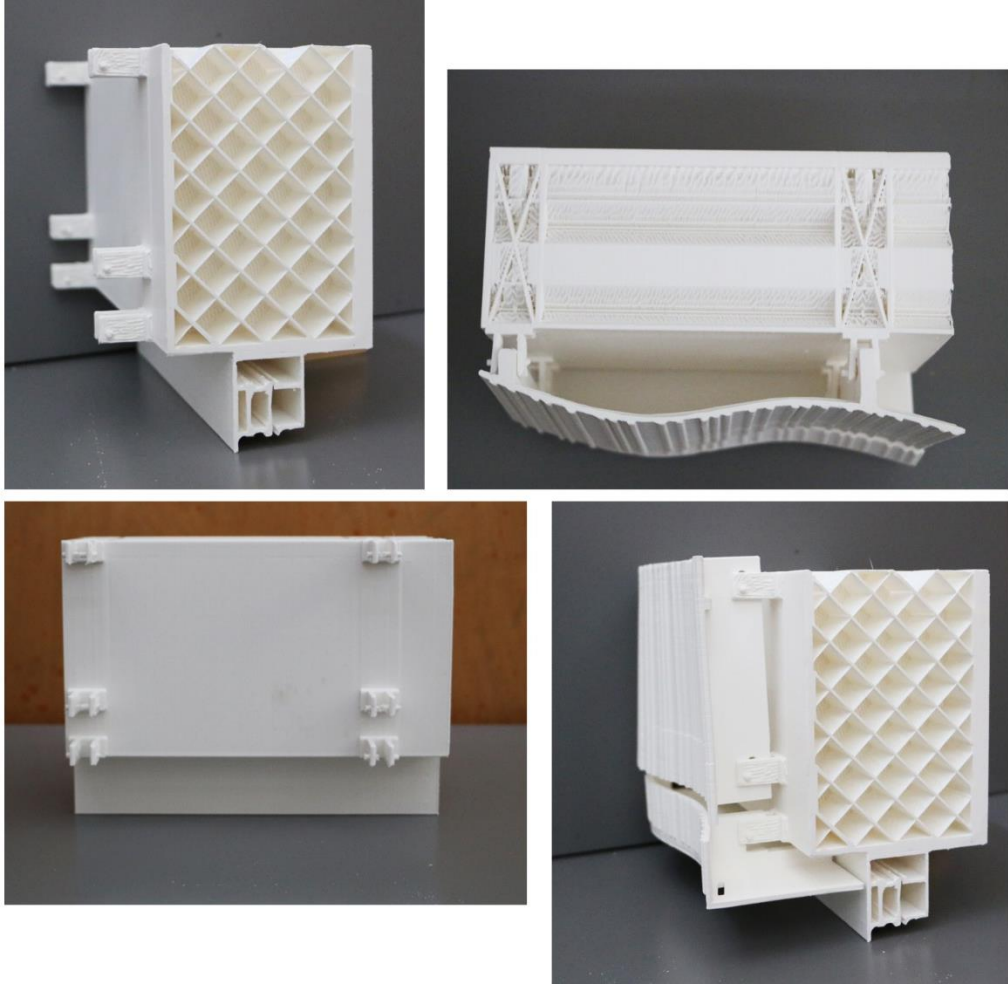
Şekil 6.6: 3B baskı için yeniden tasarlanmış detay - 1/2 ölçekli maket fotoğrafları.
