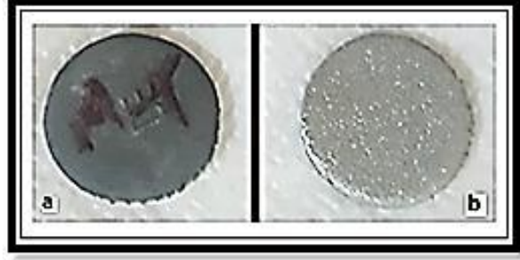
Şekil 2.12. a-) Tav-Co-Cr-W-Mo-Si Alaşımı, b-) Co-Cr-W-Mo-Si Alaşımı.
