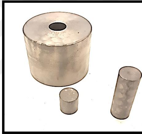
Şekil 2.4. Metal Tozlarının Preslenmesi için Kullanılan 11 mm Çaplı Baskı Kalıbı.
