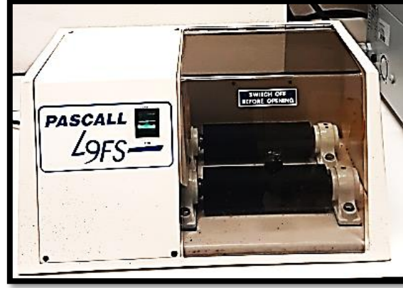
Şekil 2.3. Deneysel Çalışmada Kullanılan Pascal L9FS Öğütücü.
