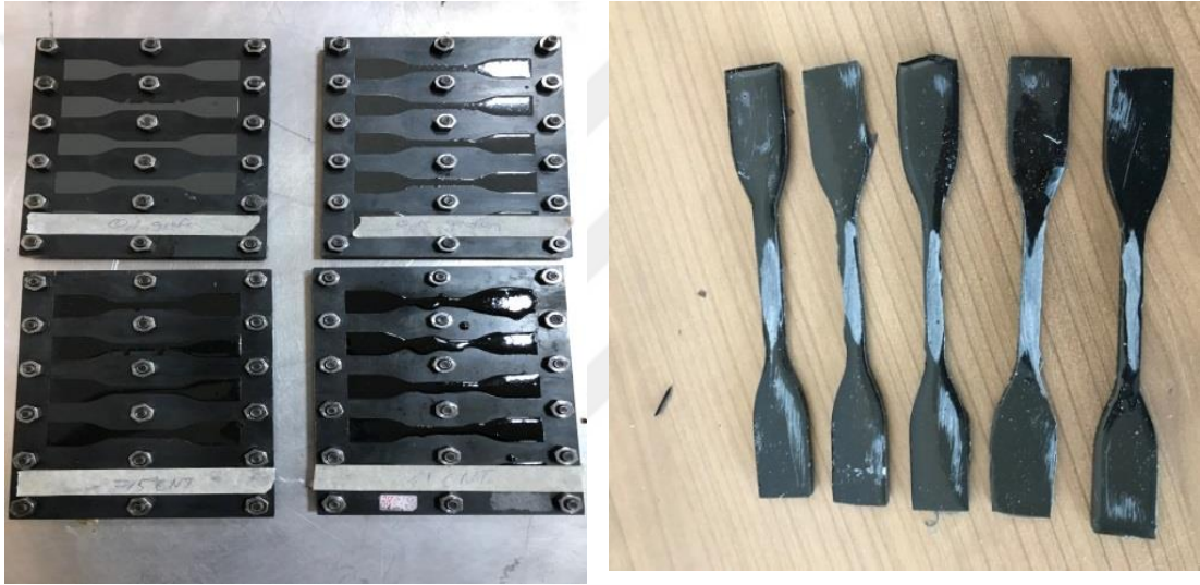
Şekil 3.19. Çekme numunesinin kalıba dökülmesi ve kalıptan çıkan çekme numuneleri
