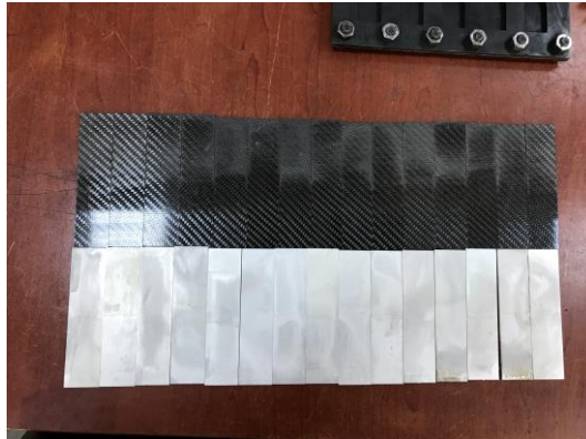
Şekil 3.17. Yüzeyleri hazırlanmış alüminyum ve kompozit levhalar
