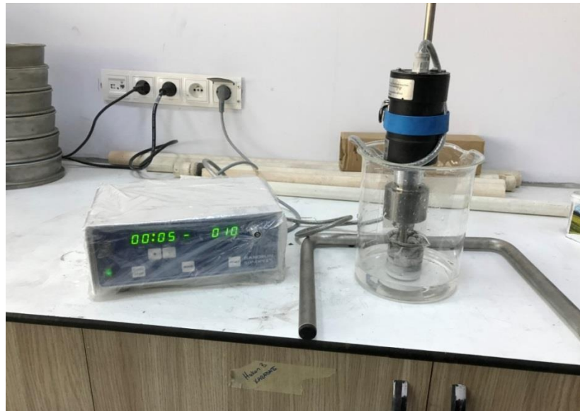
Şekil 3.18. Nanoparçacık katkı yapıştırıcının ultrasonik karıştırma ünitesi ile karıştırma işlemi
