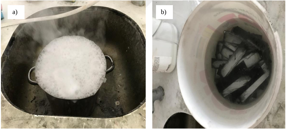
Şekil 3.14. (a) Alüminyum levhaların sodyum hidroksit çözeltisi ile temizlenmesi
