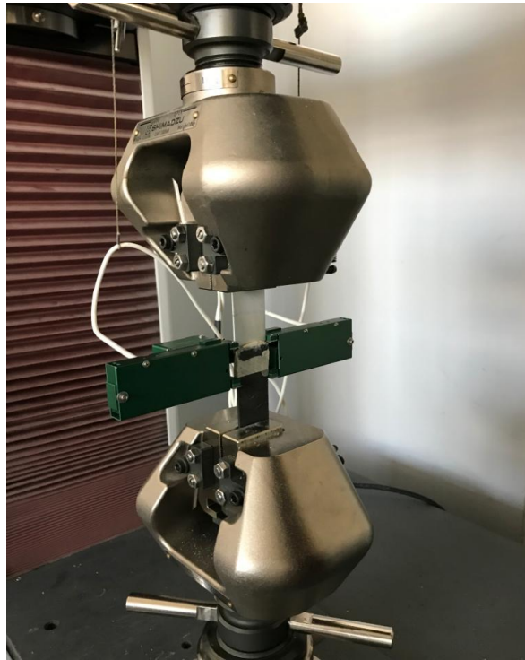
Şekil 4.6. Yapıştırılmalı bağlantının Shimadzu AGS-X cihazında çekme testi.
