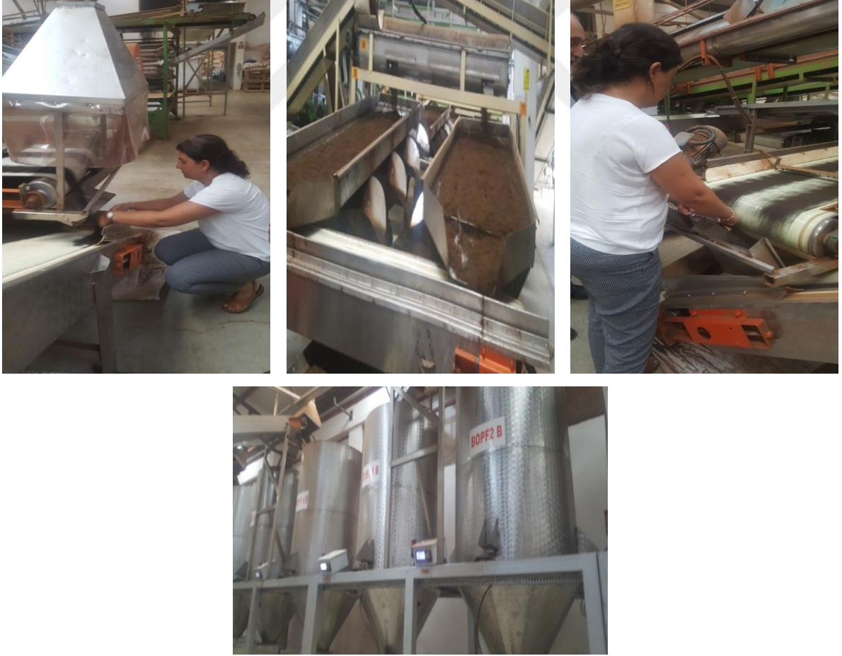
Şekil 3.6. Tasnif Aşaması ve Tasnifi Yapılan Siyah Çay ve Lif Örneklerinin Alınması
