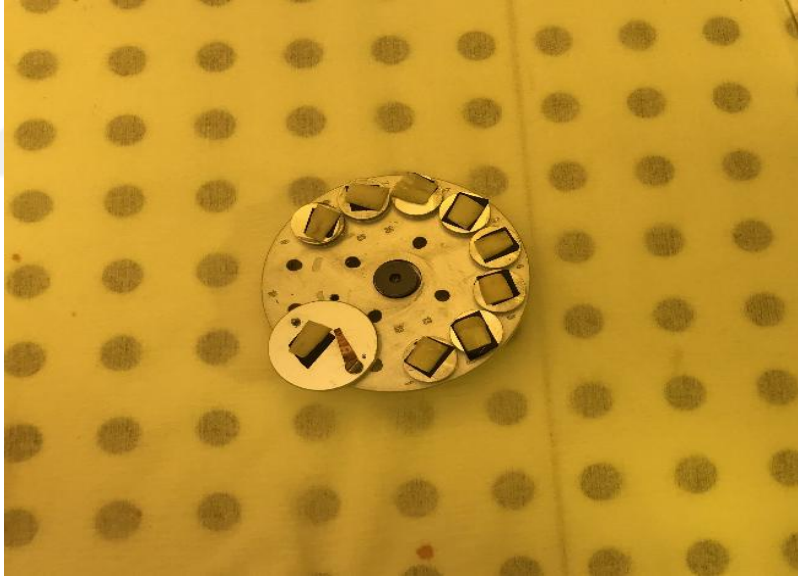
Resim 23. Örneklerin Al plakalara yerleştirilmesi.
