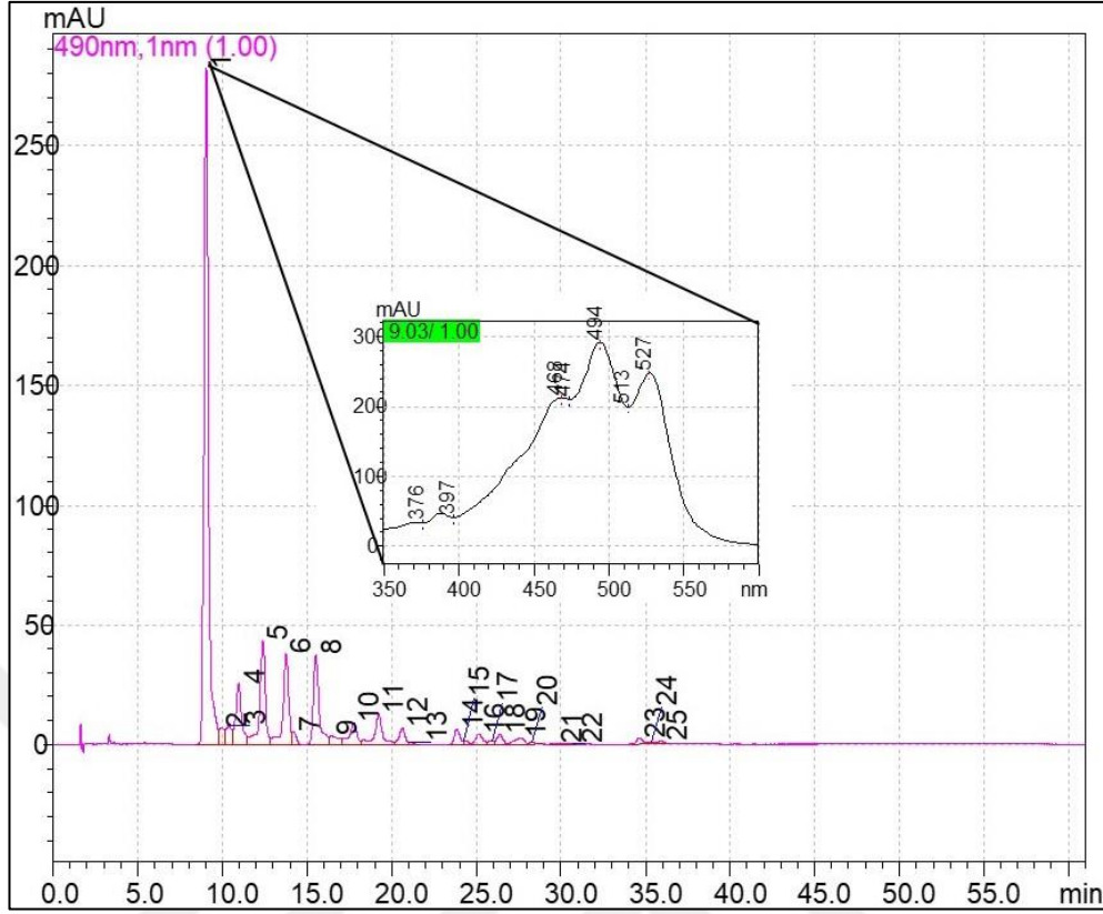
Şekil 4.40 Haloarcularia salaria HST01-2R' dan elde edilen karotenoid ekstraktına ait HPLC kromatogramı ve all-trans bakterioruberin pikine ait spektrum taraması
