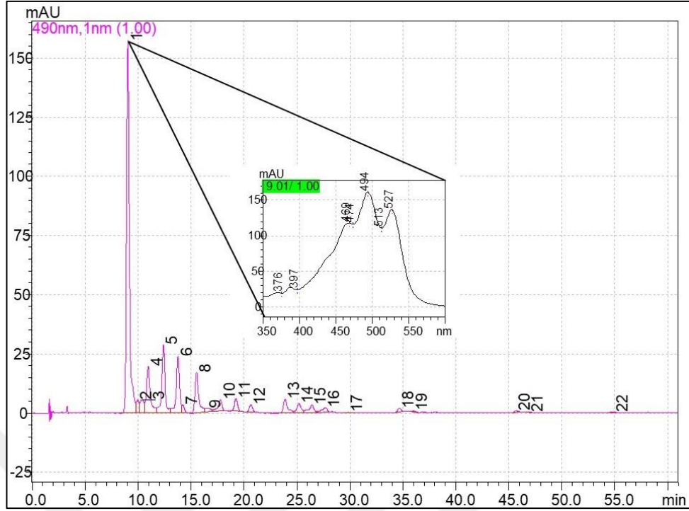
Şekil 4.43 Haloarcula japonica JCM 7785’den elde edilen karotenoid ekstraktına ait HPLC kromatogramı ve all-trans bakterioruberin pikine ait spektrum taraması
