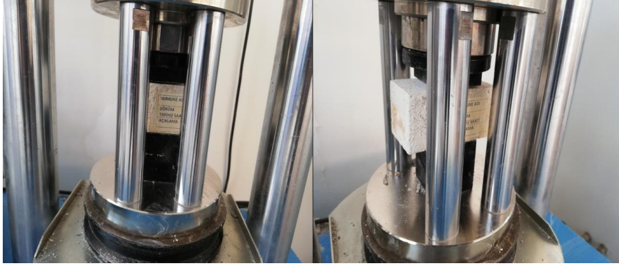
Şekil 3.13. Basınç dayanımı deneyi uygulanan harç numunesi
