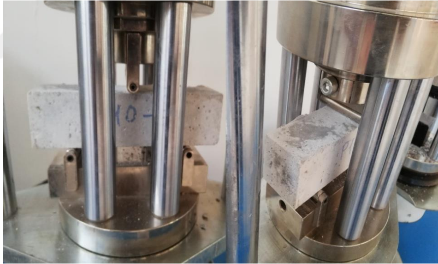
Şekil 3.12. Eğilme dayanımı deneyi uygulanan harç numunesi
