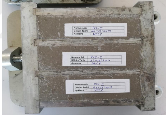
Şekil 3.5. Üç gözlü çelik kalıba yerleştirilmiş harç
