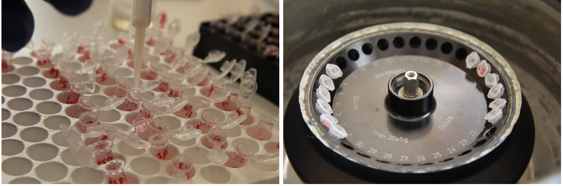
Şekil 3. Kâğıt striplerden DOS izolasyonu sırasında santrifuj cihazının kullanımı
