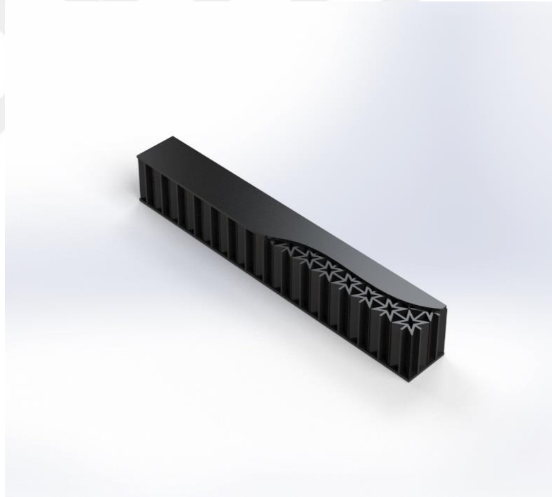
Şekil 3.7 : Üç nokta eğme modeli Yıldız sandviç yapı.
