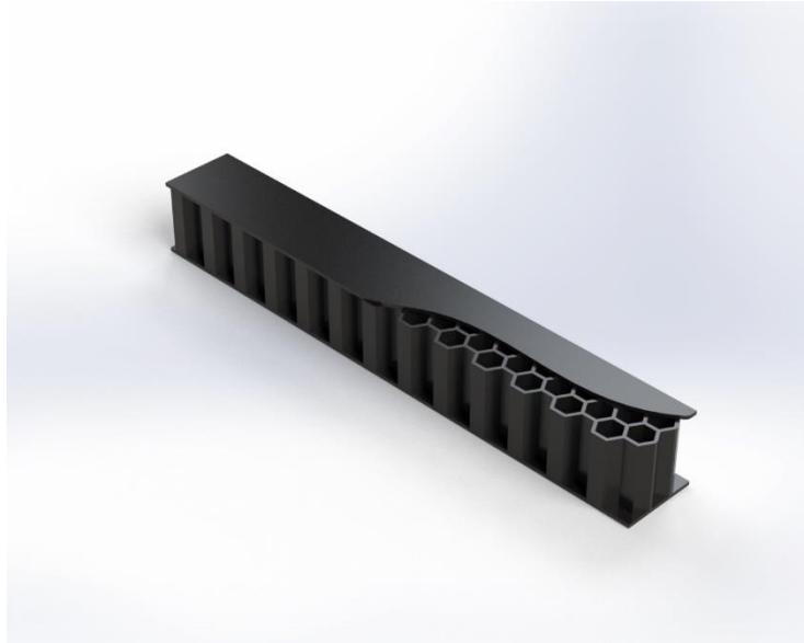
Şekil 3.5 : Üç nokta eğme modeli Bal peteği sandviç yapı.
