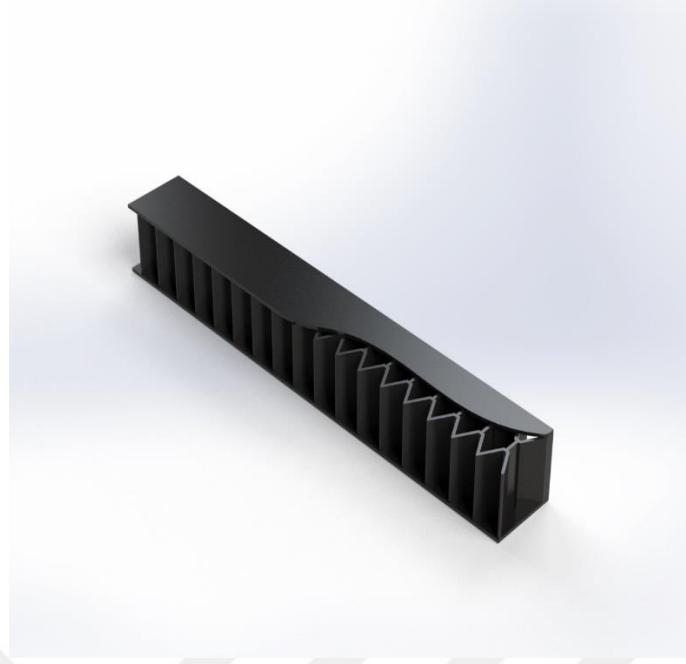
Şekil 3.8 : Üç nokta eğme modeli Üçgen sandviç yapı.
