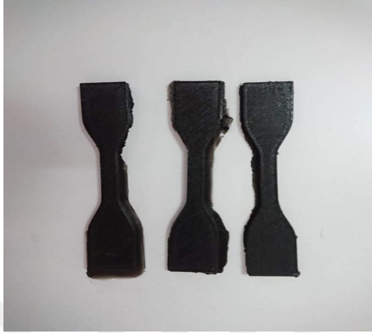
Şekil 3.16 : İmal edilmiş Çekme test numuneleri.
