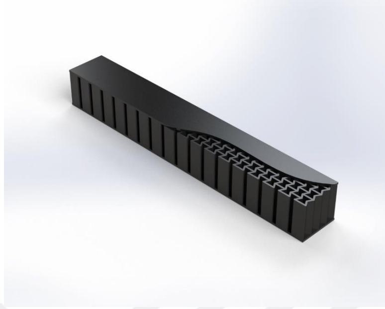
Şekil 3.6 : Üç nokta eğme modeli Girintili sandviç yapı.
