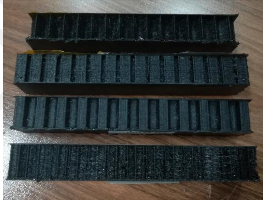
Şekil 3.13 : İmal edilmiş Üç nokta eğme test numuneleri.
