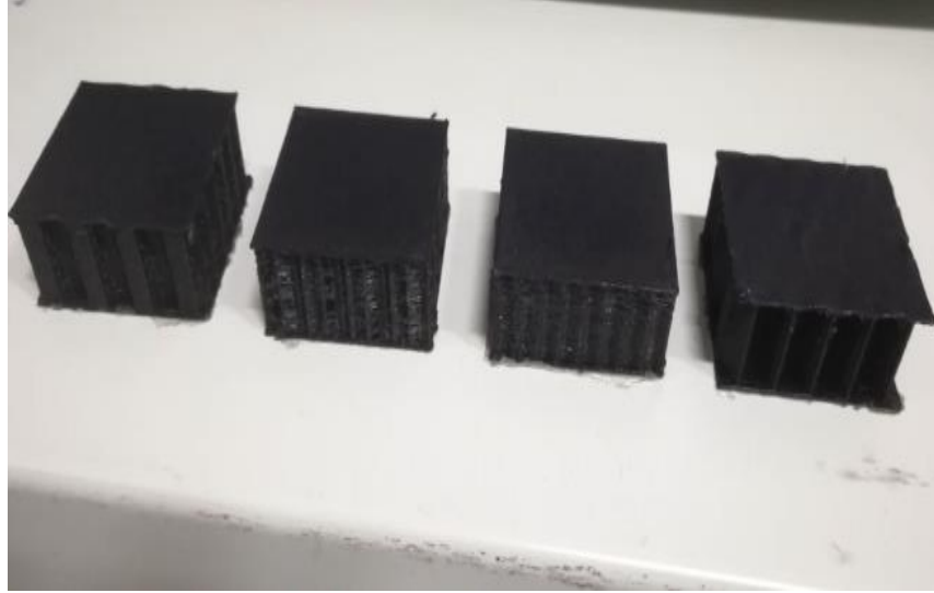
Şekil 3.12 : İmal edilmiş Basma test numuneleri.
