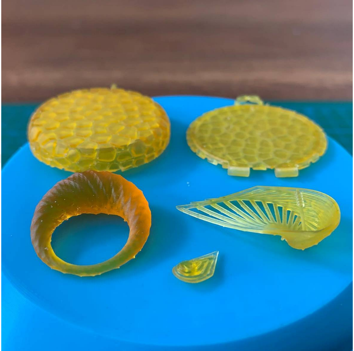
Şekil 124: Anycubic Photon 3b yazıcı kullanılarak SLA baskı ile üretilmiş, fotopolimer döküm reçinesi çıktıların tümü
