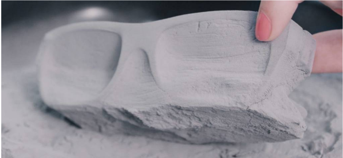
Şekil 47: PBF ile üretilmiş bir objenin üretim tablasından alınması
