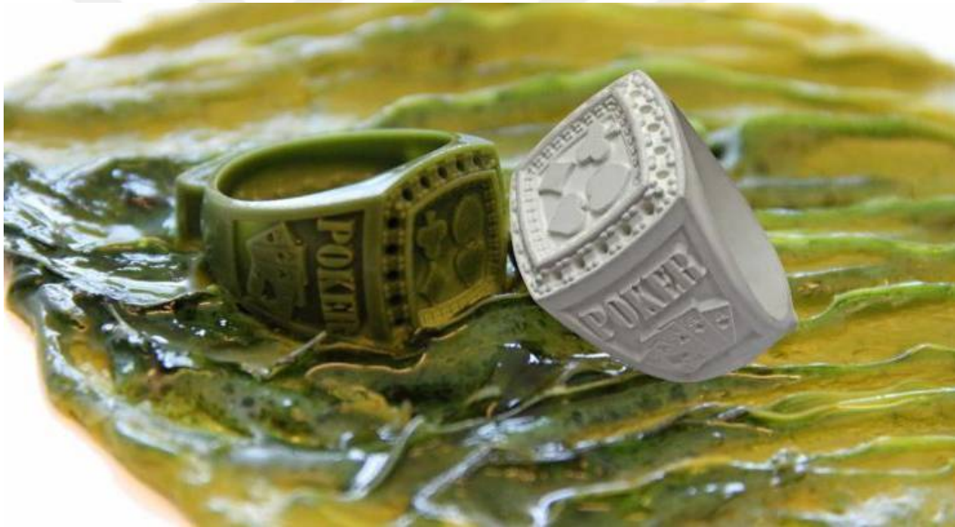
Şekil 36: DLP tipi bir yazıcı ile üretilmiş mum kalıp
