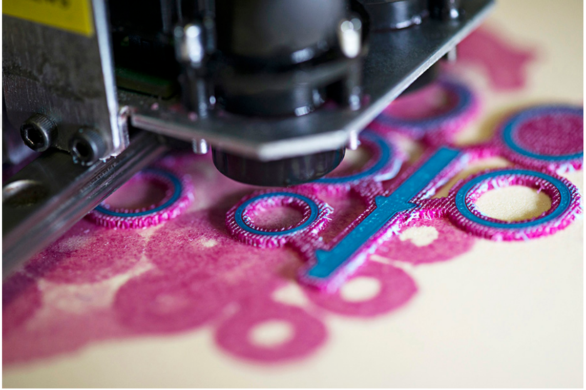
Şekil 42: FDM yazıcı ile mum kalıp hazırlama süreci
