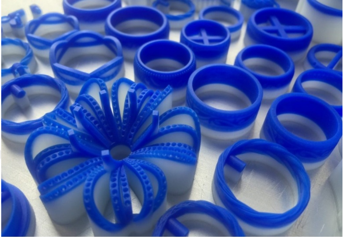
Şekil 65: MJ ile oluşturulmuş mum kalıp yüzük modelleri
