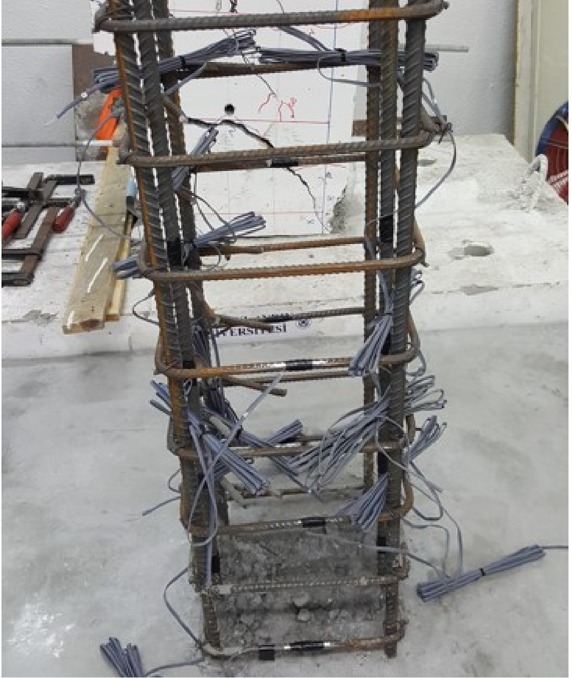
Şekil 2.12 Şekildeğiştirme ölçerlerin bağlanması
