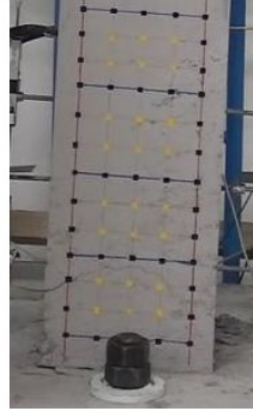
%2.8 (sargısız betonda ezilme)
