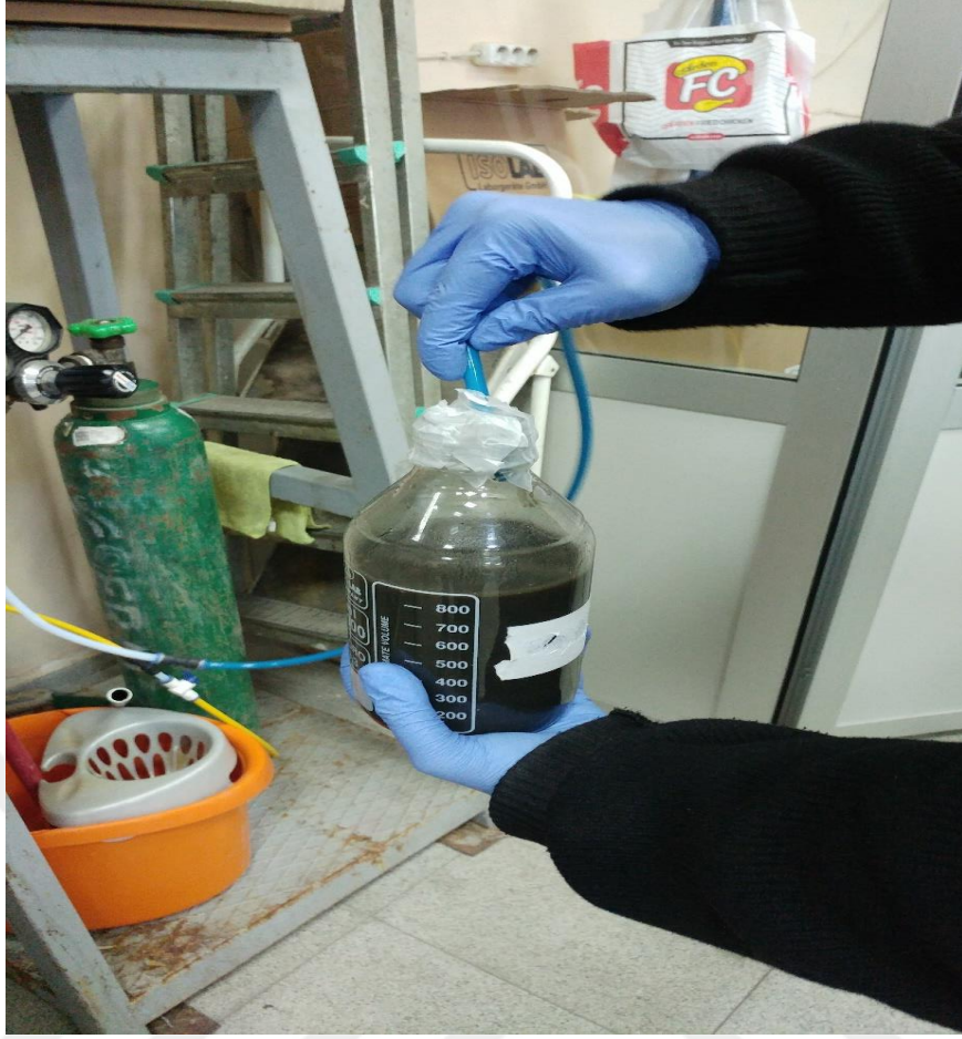
Şekil 4.1 BMP şişelerinin azot gazı yardımıyla yıkanması
