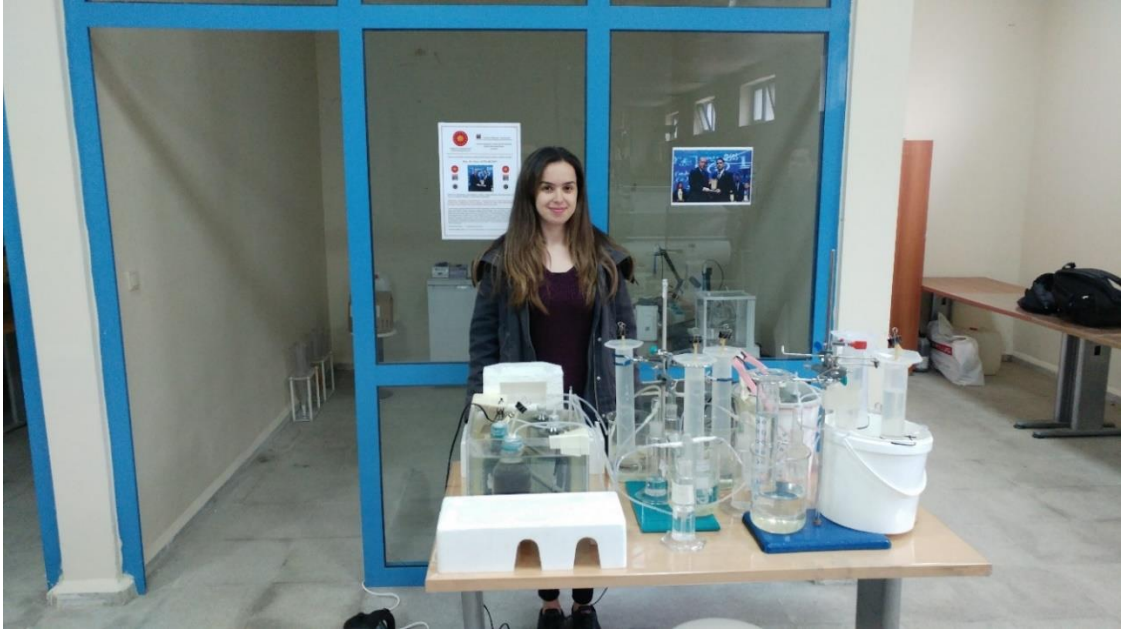
Şekil 4.3 BMP deney düzeneği (TÜBA-GEBİP 2018 laboratuvarı)
