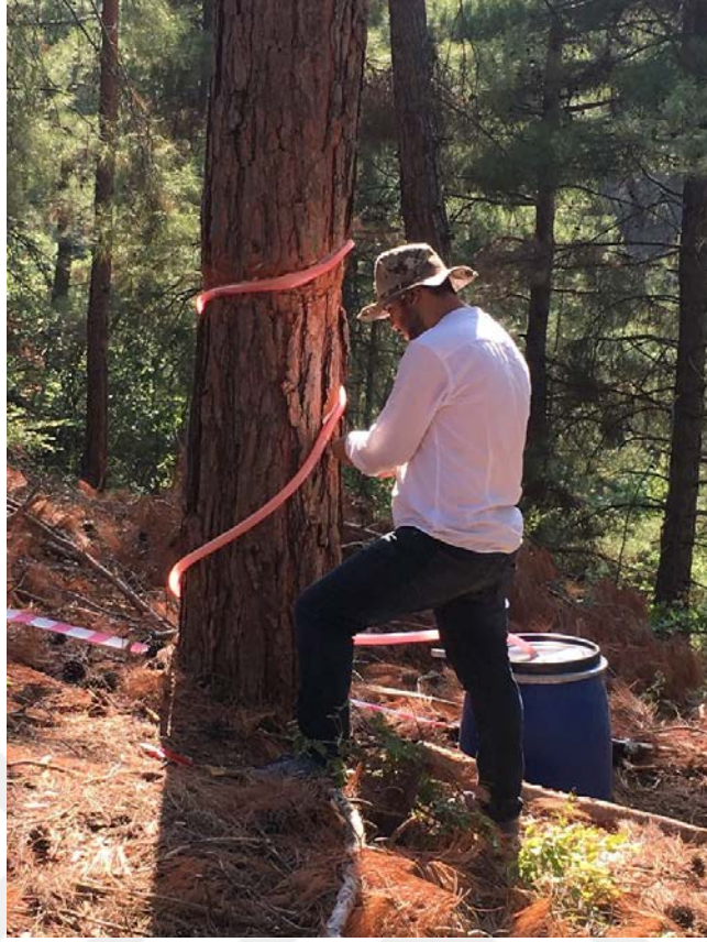
Şekil 3.16. Gövdeden akışı ölçmek için kurulan düzenek (Fotoğraf: Dilara Beyza KILBAŞ)
