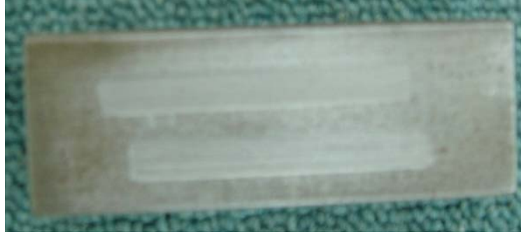
Şekil 4.38. Ray numunesindeki aşınmış yüzey
