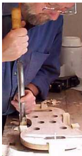
Köşe takozlarının şekillendirilmesi
