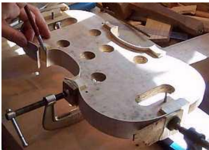
Köşe takozlarına yapıştırılmak üzere hazırlanmış yanıklar
