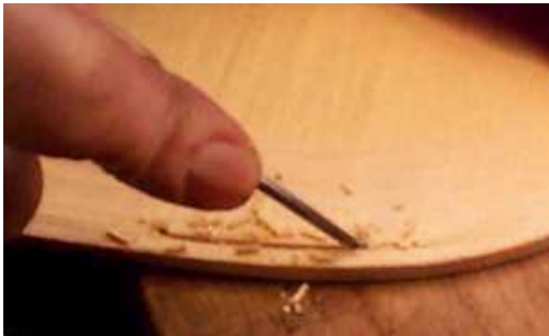
Filato kanallarının yerlerinin açılması
