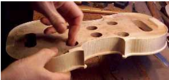
Kalıbın alt kapak ve yanlıkların içinden alınması
