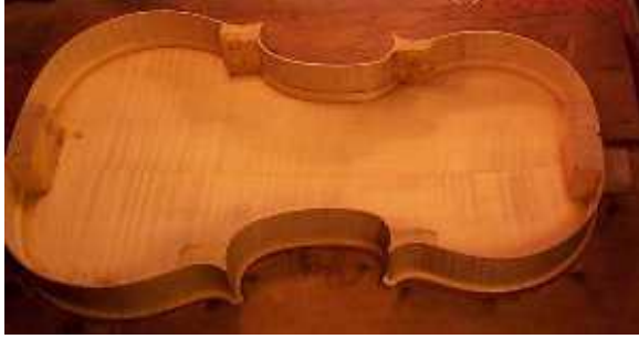
Alt kapak ve yanlıkların kalıp
