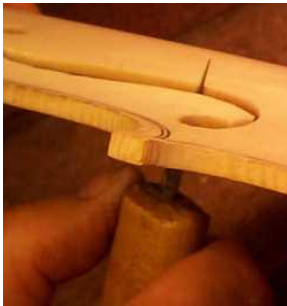
Bıçak yardımıyla kesilen yerin düzgünleştirilmesi
