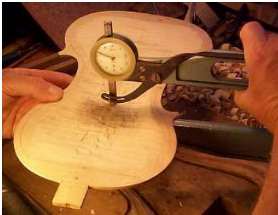
Saatli kumpas ile kalınlığının kontrol edilmesi
