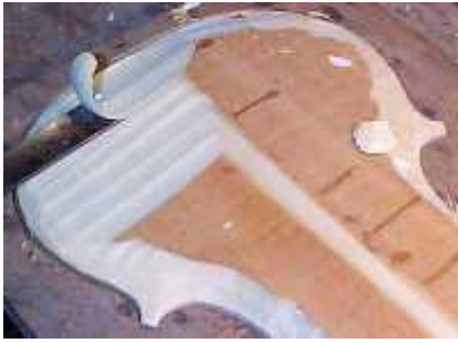
Kapağın dış bombesini verilmesi
