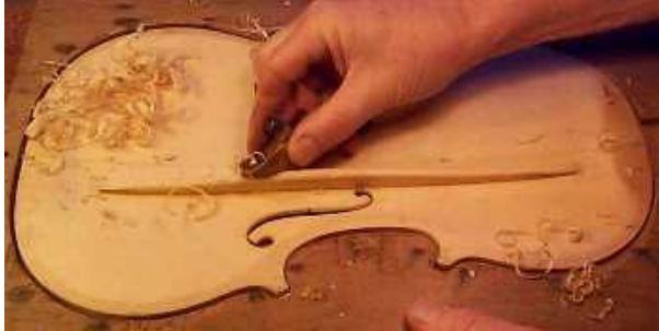
Basbalkon'a son şeklinin verilmesi
