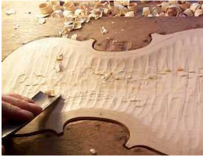
Kapakların iç kısımlarının iskarpela ile oyulması
