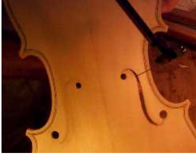
F deliklerinin kesilmesi
