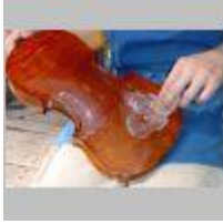
Cila kuruduktan sonra kemanın parlatılması
