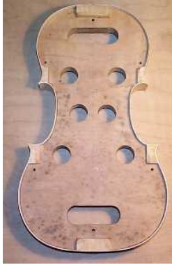
Yanlıkların köşe takozlarına yapışmış hali
