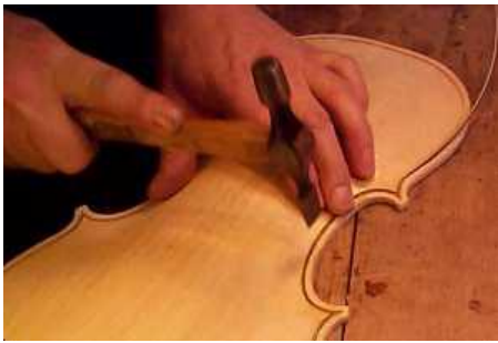
Açılan kanallara filatoların yapıştırarak çakılması
