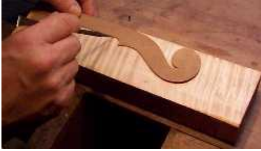
Sap kısmının kesim yerinin belirlenmesi
