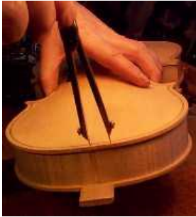
Sap'ı yerleştirmek için açılacak yerin tespiti
