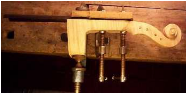
Sap kısmına tuşenin yapıştırılması
