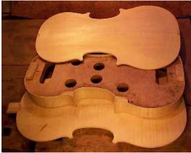
Dış bombeleri bitmiş alt kapak, üst kapak ve yanıklar
