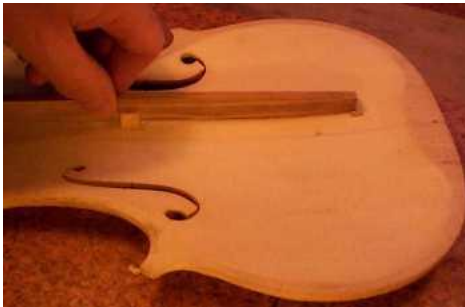
Basbalkonun ayarının yapılması
