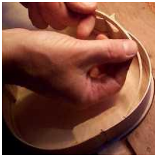
Yanlıkların üst kısmına mukavemet çitlerinin yapıştırılması
