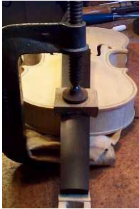
Sap'ın açılan yere yapıştırılması
