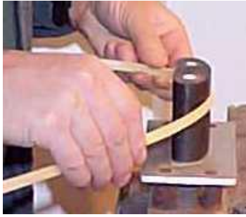
Mukavemet cıtalalarının ısıtılarak şekil verilmesi
