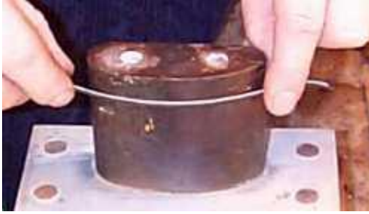
Filatoların ısıtılarak şekil verilmesi
