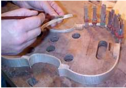
Mulavemet cıtalalarının yapıştırılması
