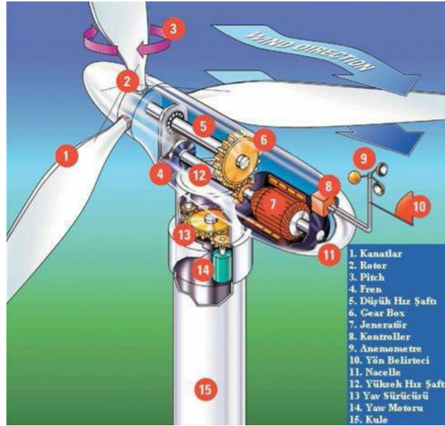
Şekil 2.8. Bir rüzgâr türbininin elemanları
