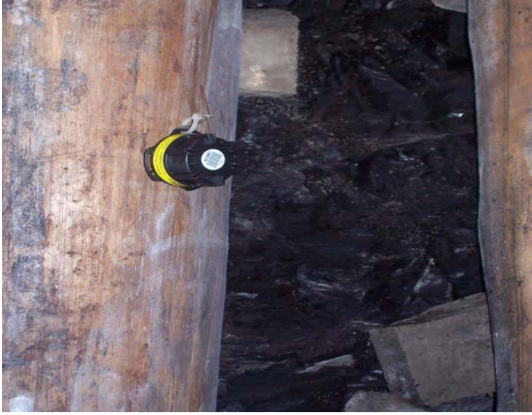
Resim 5.8. 3 nolu kömür ocağına konulan radon gazı detektörü.
