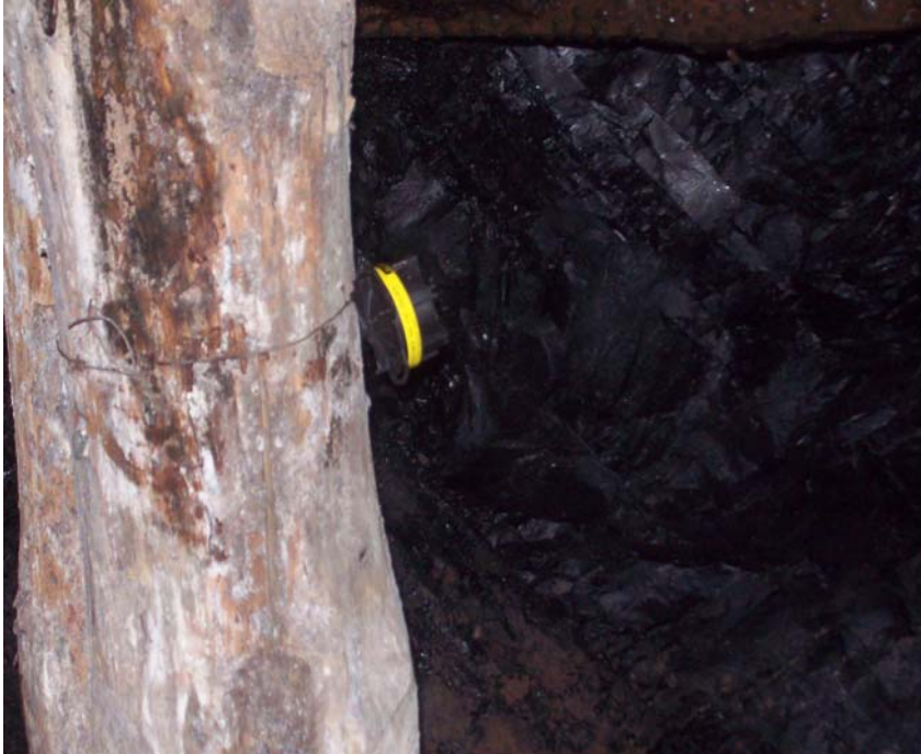
Resim 5.3. 1 nolu kömür ocağı içerisine yerleştirilen Cr-39 radon gazı detektörü.
