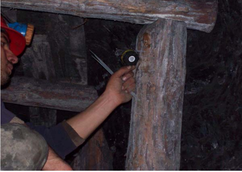
Resim 5.7. 3 nolu kömür ocağına radon gazı detektörünü yerleştirirken.
