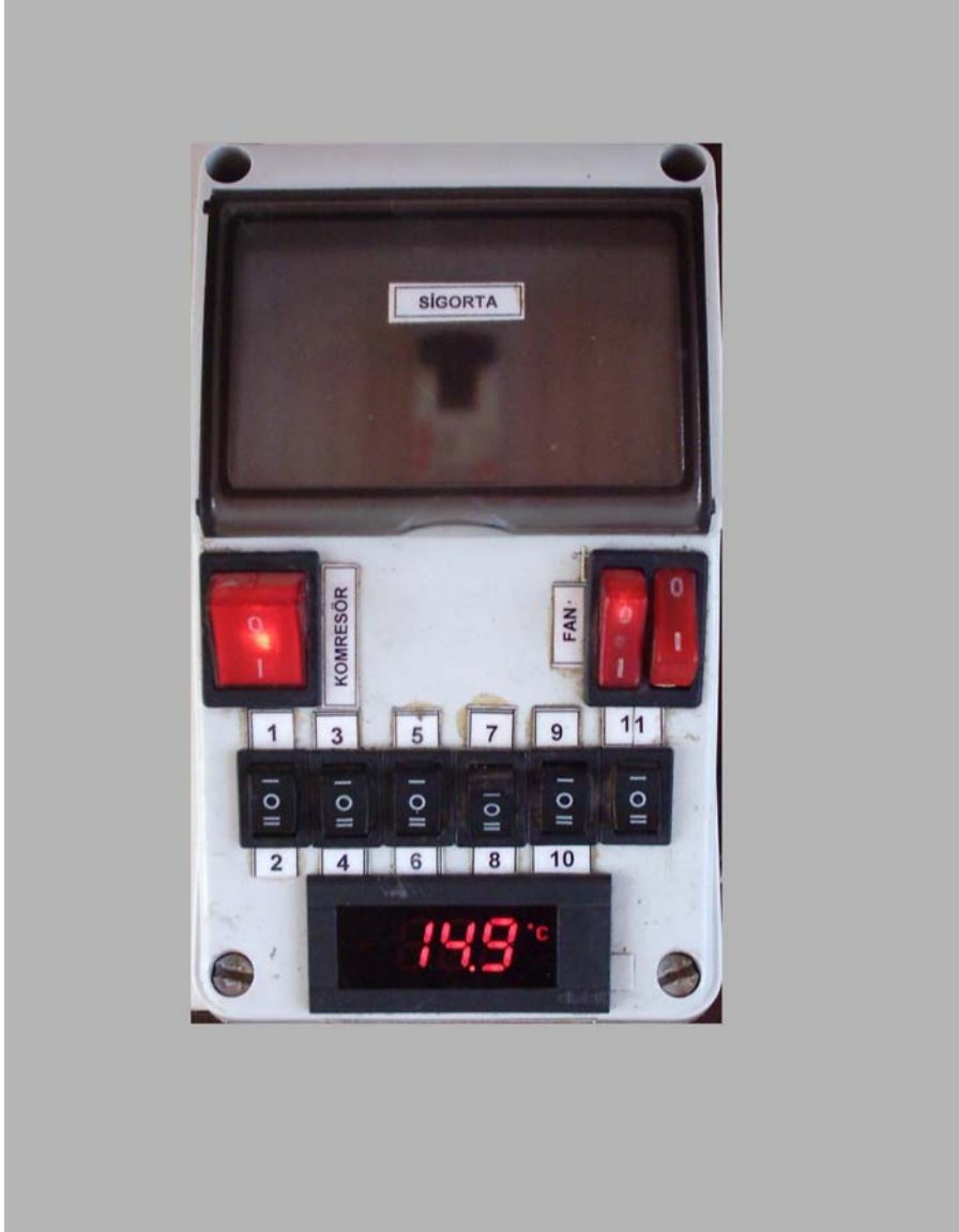
Resim 7.3. Deney düzeneği kontrol panosu ve çok kanallı termometre
