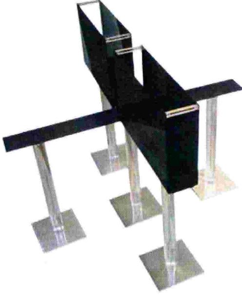
Şekil 5: Yükseltilmiş artı labirent testinde kullanılan düzenek
