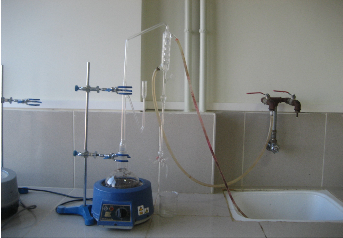
Şekil 3.2.1. Çeşitli bitkilerden uçucu yağların laboratuarda elde edilişi
