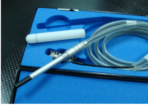
Şekil 3.6. Scanditronix Wellhöfer marka 0.65 cc farmer tipi iyon odası
