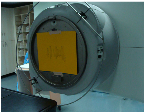
Şekil 3.26. Picket Fence testi düzeneği
