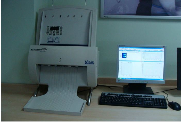
Şekil 3.12. Vidar marka DosimetryPRO Advantage film tarayıcısı
