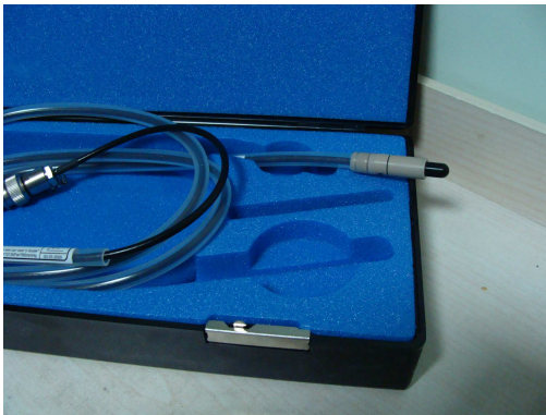
Şekil 3.7. Scanditronix Wellhofer marka 0.13 cc iyon odası
