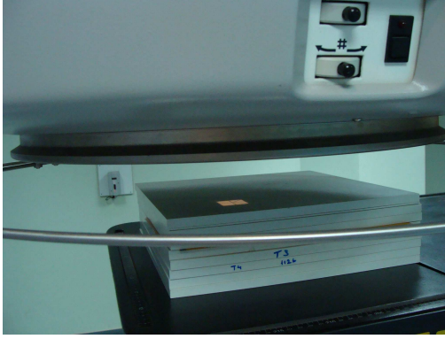
Şekil 3.17. Düşük MU değeri için simetri ve profil ölçüm düzeneği
