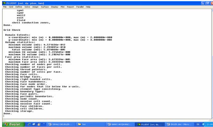
Şekil 4.10. Gridlerin kontrol edilmesi
