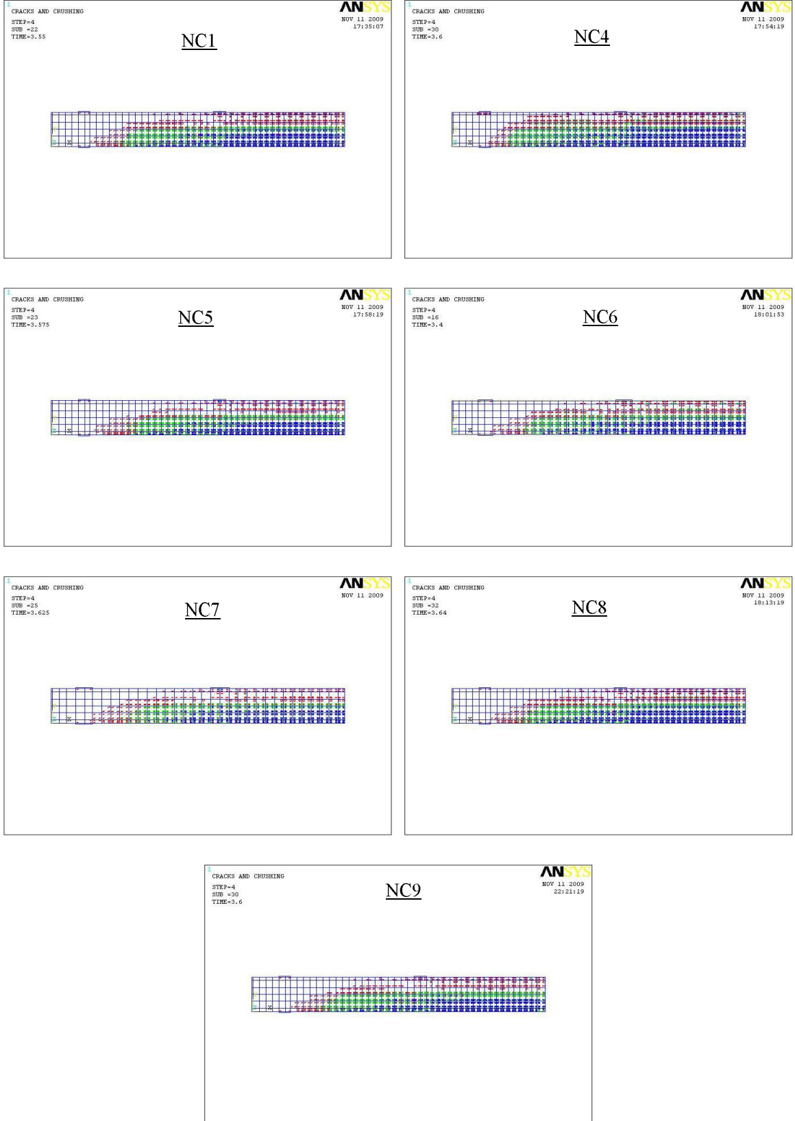
Şekil 5.18 Çözümlemesi yapılan kolonlara ait çatlak grafikleri (GÇ)
