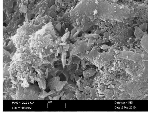
Şekil 5.3 Zeolit ile Zn(II)'nin adsorpsiyondan sonraki SEM görüntüsü
